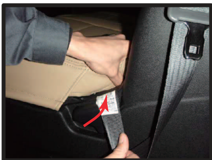
⑤ シート側面シートベルト部分の生地をプラスチックカバーの間に入れ込みます。
