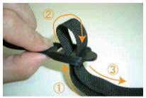
7 ベルトは、図の①~③の順番にバックルに 通します。通したベルトを引く事で、ベルトが締まり固定されます。 強く引き過ぎるとベルトが切れる恐れがありますので慎重に作業して下さい。
