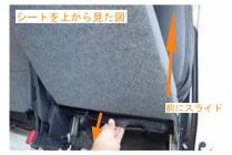
3 シートを一番前にスライドさせ、背もたれ と座面の隙間に生地を入れ込んだ後、背面 側から生地を引き出します。背もたれの角 度を調整して入れ込みやすい角度で行って 下さい。
