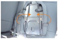
6 ヘッドレストのラインからずれないようにカバーを左右均等になじませながらシート全体にかぶせ、カバーに付いているベルトをバックルに通します。ベルトの通し方については、7番を参照下さい。
