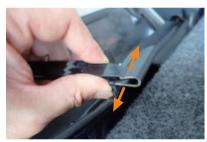
5 プラフックが固定しにくい場合は、付属の ヘラを使用し、プラフックの隙間を少し広 げるようにします。
