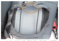
5 カバーに付いているタグに「右席」と記載されている方が運転席用です。 始めにカバーの上下を確認します。 図の○部の形状を確認し、ヘッドレストの 軸部分をかわす作りになっている方が上側 になります。
