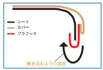
4 引き出した生地に付いているプラフックを図のようにシートのフチの硬い部分に巻き込むように固定します。
