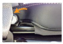
10 側面の生地をシートと金属部分の隙間に入れ込みます。
