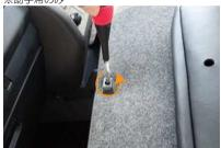
8 カバーをかぶせる前に、助手席背面に付い ているゴムパーツをドライバーを使用し外 します。
