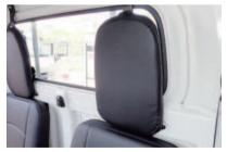
9 助手席ヘッドレストは、カバーに「左席」 のタグが付いているかを確認して下さい。 運転席と同様にカバーを取り付けます。
