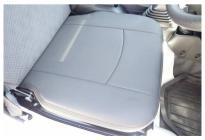
12 カバーのラインを整えて、運転席座面の完成です。 助手席も同様に取り付けます。
