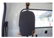
1 始めにヘッドレストを車体から取り外します。ヘッドレストは、図の3箇所(○部)にボルトで固定されています。
