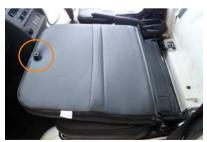
9 運転席と同様にカバーを装着し、カバー背面の加工穴とネジ穴が合っていることを確認し、外したゴムパーツを元に戻します。
