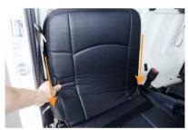
2 シートのラインからずれないようにカバーを左右均等に引き下げてシート全体にかぶせます。
