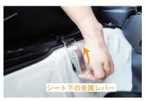
7 シート下にある金属レバーを持ち上げるようにして、ロックを解除します。
