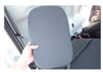
4 3箇所のボルトを外すと、ヘッドレストが 車体から取り外せます。 この状態で、ヘッドレストにカバーを取り 付けます。
