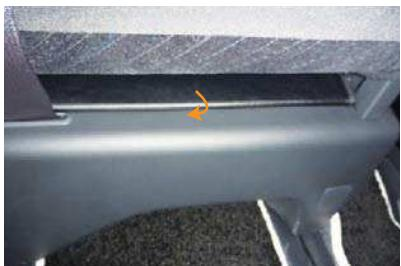
7 引き出した生地に付いているプラフックを9ページ1番、2番で取り外した純正フックの代わりにシートに固定します。外した純正フックはカバーの中に入れ込みます。
