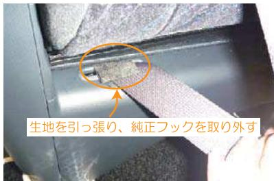
1 シート背面のシートベルト出口にある図の生地を手前に引っ張り、シート表皮を固定している純正フックを取り外します。
