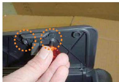
5 2番で外したボックスのフタにカバーをかぶせます。フタ裏の図の部分を、ドライバーを使用してネジを2本外して取り外します。
