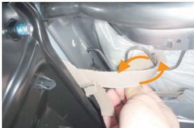
15 6ページ12番で引き出したベルトを、シート裏の金属部分に巻き付けて折り返し、マジックテープを固定します。
