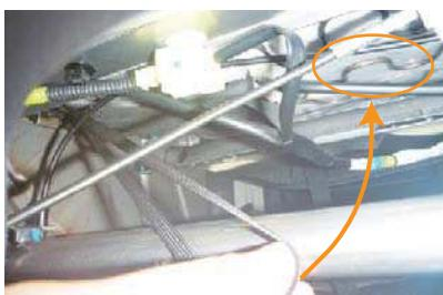
11 シート底面からゴムを引き出し、金属部分へ固定します。
