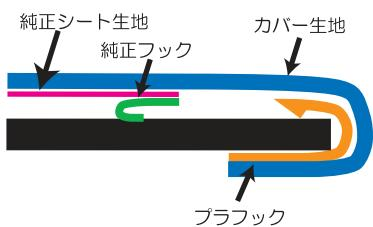
8 プラフックは図のようにカバーの生地を巻き込むようにして固定します。
