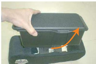
2 ボックス裏にツメが引っかかっているので図の矢印方向へスライドさせてからボックスを外します。
