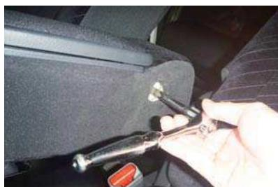
5 ソケットレンチ等を使用してボルトを外します。(14mm)
