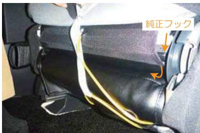
1 5ページ1番で外した生地をめくり、シート表皮を固定している純正フックの固定を端から外します。サイドエアバッグやシートヒーター装備車は配線に気を付けながら慎重に作業を行って下さい。
