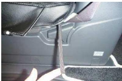
10 カバー外側面のゴムに付属のS字フックを付けてシートの隙間へ通します。
