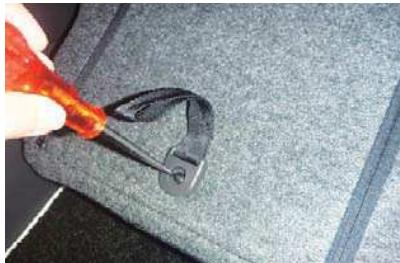
1 シート背面のベルトをプラスドライバーを使用して外します。（3箇所。20ページ11番参照）
