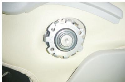
11 シートリフター装備車は、シートリフターの軸部分にカバーの加工穴を合わせます。
