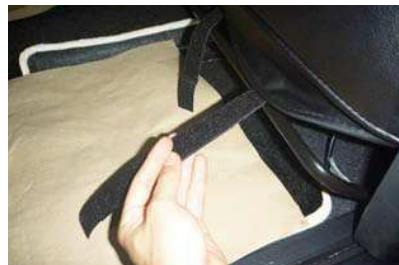
16 カバー前側に付いているマジックテープベルトをシート底面の金属部分に巻き付けるようにして固定します。
