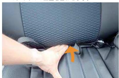
17 背もたれと座面の隙間に生地を入れ込みます。背もたれの角度を調整して、入れ込みやすい位置で作業を行って下さい。
