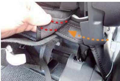
19 引き出した生地の端と**16番**でプラスチックパーツの内側を通した生地の端を、マジックテープで固定します。
