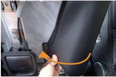
14 カバー側面の生地をシートに馴染ませながら、シート背面で純正シート地を固定しているフックの上から、カバーのフックを引っ掛けで固定します。
