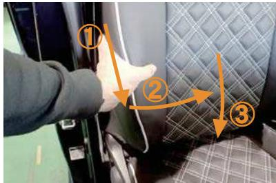
14 ①～③の順番に、カバー側面の生地を引き下げながら中央へ寄せせて、中央で余った生地を下へ撫で下ろします。シートの下に余った生地を13番と同様にシート裏から引き出して、生地をシートに密着させていきます。
