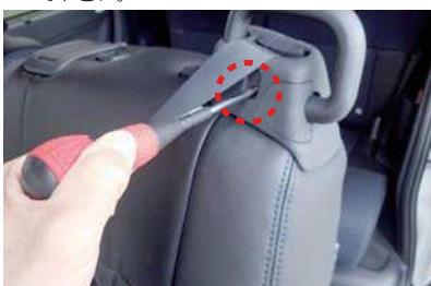
25P▶ 30 29番の確認でも解消されない場合はシートベルトの台座部分を外して確認します。まずシートベルトの裏側にあるネジを、ドライバーを使用して外します。
