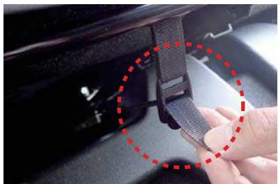
8 ベルトはシート前側のカバーに付いているバックルに通して固定します。
