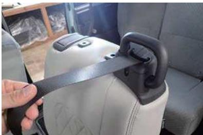
28 シートカバー装着後、図のようにシートベルトを引っ張り、手を放して問題なくシートベルトが巻き取られるか確認して下さい。シートベルトの巻き取りが明らかに鈍いと感じた場合は、29番からの内容を確認して下さい。
