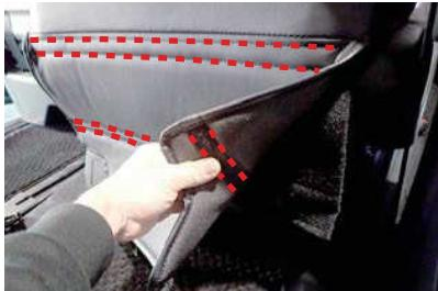
25 カバー背面下の図の点線部分にマジックテープが2か所付いています。
