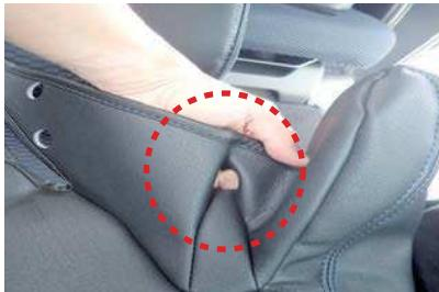
13 カバーを装着する前に確認して下さい。カバーのシートベルトバックルが収まる位置辺りの生地には、図のように穴が開いています。穴は何かを通すために開いている訳ではありません。バックルなどを通そうとしないように、注意して下さい。
