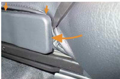
15 シート外側のプラスチックパーツ部分です。シートとプラスチックパーツの隙間にヘラなどを使用して生地を入れ込みます。
