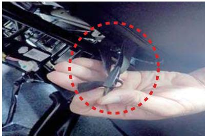
25 引き出したベルトをカバーの前側に付いているバックルに通して固定します。
