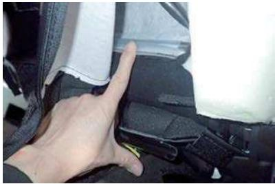
15 13番で引き出した生地の端に付いているフックを、図の人差し指で刺している純正シート地を固定しているフックの上から引っ掛けで固定します。
