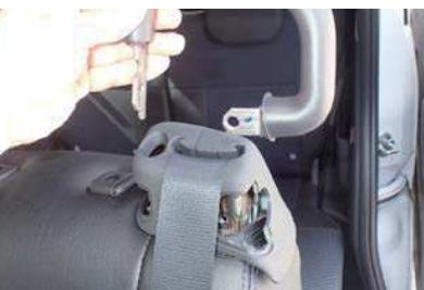
33 前側・内側ともボルトを外すと、まずシートを可動させる際に掘むアーム部分が図のように外れます。
