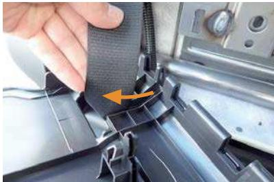
7 シートベルトをボードの隙間に通して抜き出します。
