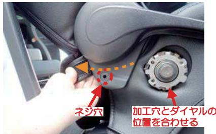
16 9番でネジを外したプラスチックパーツの内側に、図のように生地を通します。通した生地には加工穴を開けているので、ネジ穴の位置と生地の穴位置が合うようにして下さい。生地を通したら9番で外したネジを元通りに固定します。
