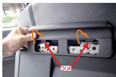
23 バックボードの上側を固定します。
