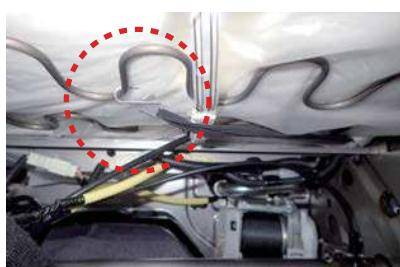
24 引き出したゴムに付属の金属フックを取り付けます。
