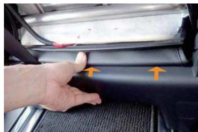
17 16番のフックはシート表皮を固定しているフックより大きく、カバーの生地も厚みがあるため、完全にはフックがはまりません。フックの先端を入れ込むように固定して下さい。
