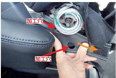
21 **20番**の位置にシートカバーをかぶせます。シートベルトのバックルの内側に生地を通して、背面側へ引き出します。
