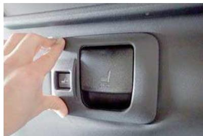
23 プラスチックパーツを生地を挟み込みながら元通りに固定します。
