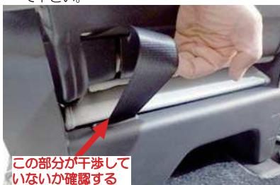
29 始めにシート背面側のシートベルトが出ている部分を確認します。
