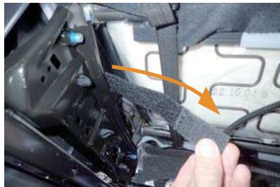
28 マジックテープのベルトをシート裏の隙間から引き出します。
