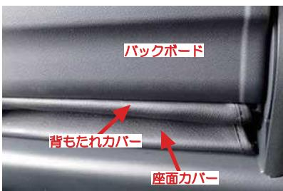
21 固定部材を全て入れ込み生地を固定出来れば、バックボードの表面側は図のようになります。
