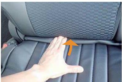
14 背もたれと座面の隙間に生地を入れ込みます。背もたれの角度を調整して、入れ込みやすい位置で作業を行って下さい。
