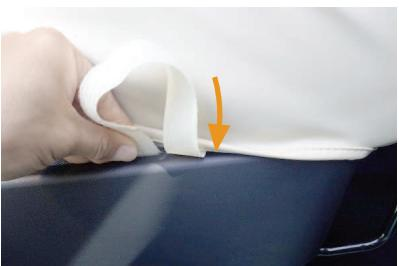
14 カバー外側に付いているマジックテープのベルトとカバーの端を、シートとプラスチックパーツの隙間に入れ込みます。
