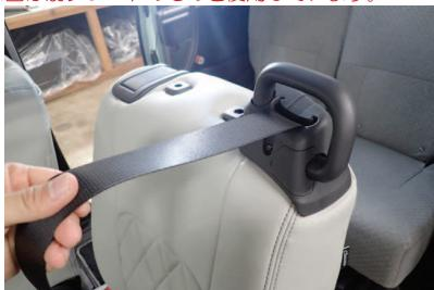
42 シートカバー装着後、図のようにシートベルトを引っ張り、手を放して問題なくシートベルトが巻き取られるか確認して下さい。
