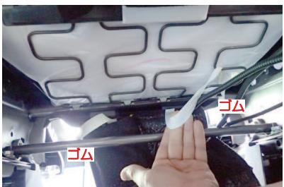
3 フックを外すとゴムが2本金属部分に引っ掛かっているのが見えてきます。ゴムを金属部分から外します。
