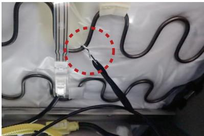
13 引き出したゴムに付属の金属フックを取り付けます。金属フックをシート裏の金属部分に引っ掛けで固定します。
