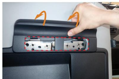
35 上側のツメの固定は、図の点線部分の枠からツメの位置を確認しながら作業を行って下さい。
