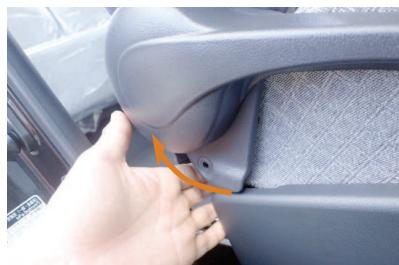
6 ネジを外してプラスチックパーツを斜め上
