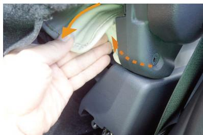
18 隙間に通した生地と13番で引き出した生地の端を、マジックテープで固定します。
