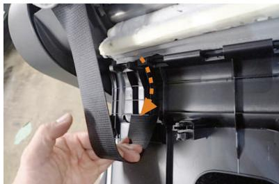
32 途中までフックを差し込んだ時点でシートベルトをボードの隙間に通します。
