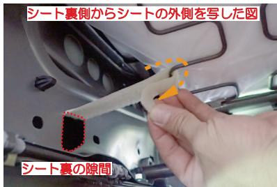
16 14番で入れ込んだマジックテープのベルトを、シート裏の金属フレームの隙間から引き出します。
