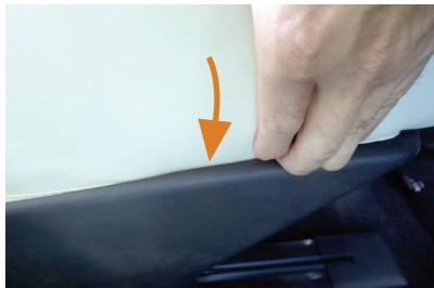
16 フックを下向きにしたまま、シートとプラスチックパーツの隙間に入れ込みます。入れ込んだ先にシートのフチがあります。フックをシートのフチに引っ掛けで固定します。前後2か所共同様に固定します。
