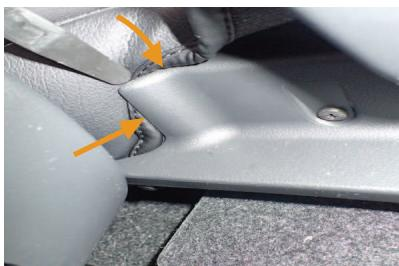
21 シート内側のプラスチックパーツ部分です。シートとプラスチックパーツの隙間にヘラなどを使用して生地を入れ込みます。
