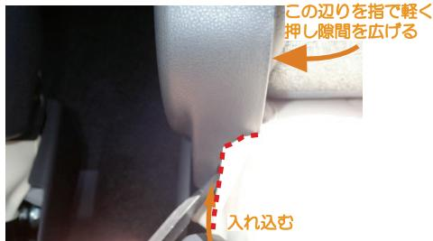
17 シート内側の付け根部分です。この位置のカバーに固定部材が付いています。固定部材を生地と一緒に図の点線部分のプラスチックパーツの隙間に入れ込みます。こちらの隙間は大変狭くなっているので生地が裂けたりしないように、作業は慎重に行って下さい。
