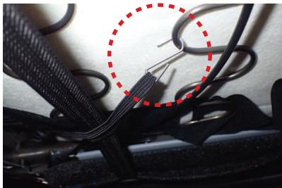
19 ゴムに付属の金属フックを取り付けて、シート裏の金属フレームに引っ掛けで固定します。
