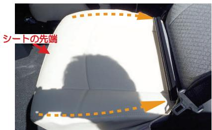
3 カバーをシートのラインに合わせて前側から後ろ側へ向けてかぶせます。
