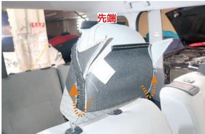
1 カバーを図のように裏返して、ヘッドレストのラインに合わせてかぶせます。ヘッドレストの先端まで生地が張るようにしっかりととかびせて下さい。カバーは平らなプラスチックが付いている方が前になります。
