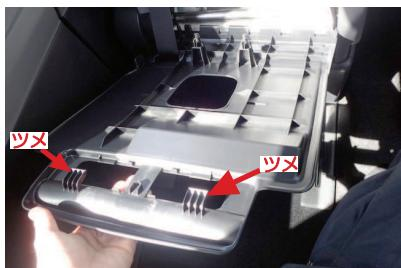
11 上側のツメが外れると、バックボードの上側と側面がシートから外れた状態になります。
