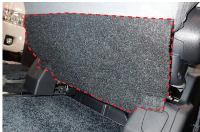
1 シート背面下の図の点線で囲んでいる生地の固定を外します。
