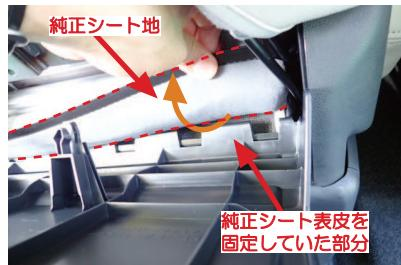
34 バックボード上側のツメを固定します。この際、13番から外した純正シート表皮を、シートクッションごと図のように純正シート表皮のフックを固定していた部分より内側に巻き込みます。
