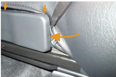
15 シート外側のプラスチックパーツ部分です。シートとプラスチックパーツの隙間にヘラなどを使って生地を入れ込みます。
