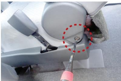
7 シート内側のシートの軸になる部分の下側にあるネジを、ドライバーを使用して外します。
