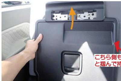
10 バックボード裏の上側に付いているツメを外します。
