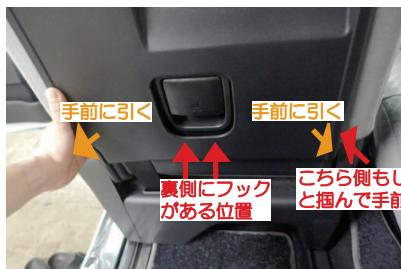
8 シート背面のバックボードをシートから外します。
