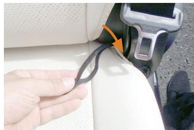
11 カバー外側の軸部分にはゴムが付いています。ゴムをシートとプラスチックパーツの隙間に入れ込みます。
