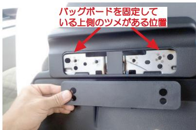
7 コンビニフックが付いていた部分の図の枠を外しておきます。
