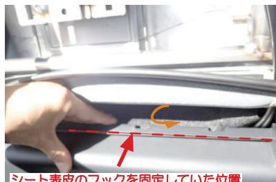
6 2番で固定を外したフックを折り畳み、引っ掛けていたプラスチックパーツの内側へと入れ込みます。
