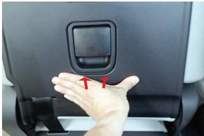
37 フックの位置を意識してボードを押し込み固定します。
