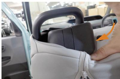
20 ファスナーを半分程度閉じた状態で、シートベルトが出ている台座部分をカバーから取り出します。
