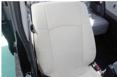
1 カバー側面のファスナーを開けた状態にして、シートのラインに合わせてカバーをシート全体にかぶせます。
