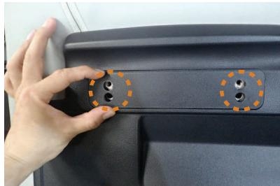
38 プラスチックパーツを元に戻します。ボルトの穴位置がしっかりとプラスチックパーツの中心に来ているか確認して下さい。
