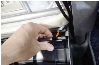
31 13番から15番で外したシート表皮のフックと同じように、カバーのフックをバックボードの下側に固定していきます。ヘラなどで広げた隙間に30番のカバーのフックを差し込みます。フックの先端が出てくるまでしっかりと差し込んで下さい。
