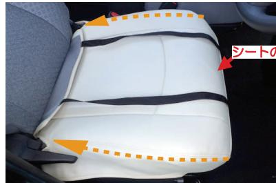
11 カバーをシートのラインに合わせて前側から後ろ側へ向けてかぶせます。
