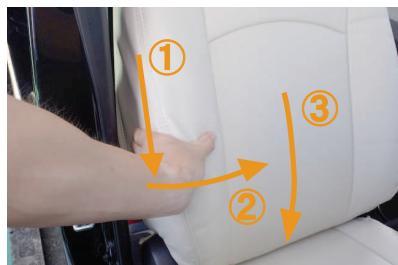
6 ①～③の順番に、カバー側面の生地を引き下げながら中央へ寄せて、中央で余った生地を下へ撫で下ろします。シートの下に余った生地を⑤番と同様にシート裏から引き出して、生地をシートに密着させていきます。
