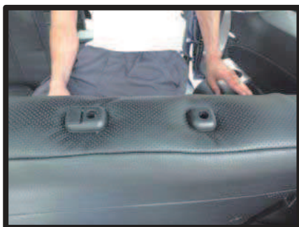
⑤ ヘッドレストの台座部分をカバーの加工穴から取り出した図です。取り出し方法は、6ページ⑤と同様です。
