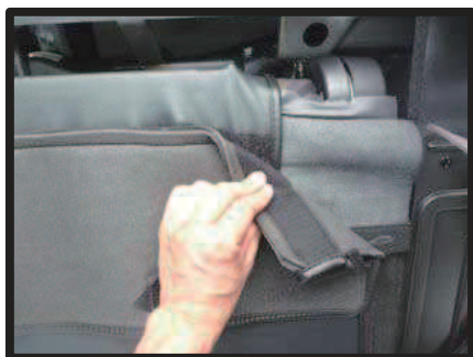
⑧カバーの背面下と⑥で入れ込んだ生地をマジックテープで固定します。この際、13ページ①で外した生地をカバーの中に入れ込みます。
