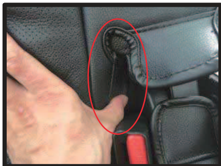
⑦側面下部の生地を背もたれとプラスチック部の隙間に入れ込みます。
