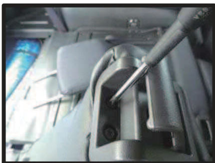
⑪リクライニングレバーのネジをドライバー等で緩め、カバーをシートとプラスチックの隙間に入れ込みます。
