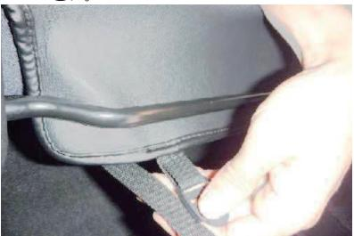
8 9ページ4番で引き出した生地に付いているベルトを座面裏を通してシートの前側から引き出します。
