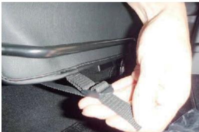
9 1列目座面と同様にしてベルトとバックルを固定します。
