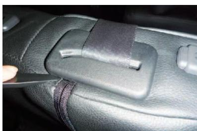
11 シートベルト周りの生地をシートとプラスチック部の隙間に入れ込みます。
