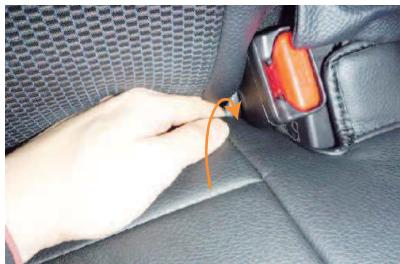
1 シート内側後方の角にカバーを引っ掛けるようにかぶせます。
