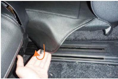
7 カバー内側面に付いているゴムに付属のS字フックを結んで座面裏の金属部分に固定します。
