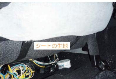
8 ベルトは図のようにシートの生地の上から後ろ側へ出し、5ページ4番で引き出した生地に付いているバックルと固定します。
