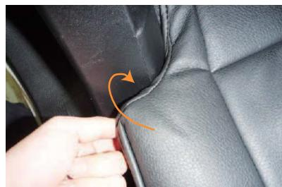
5 シート外側後方の角にカバーを引っ掛けるようにかぶせます。
