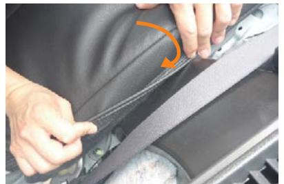
11 シート側面の生地をマジックテープで直接シートに貼り付けて固定します。
