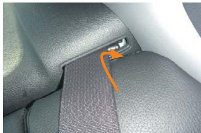
8 サイドパーツ先端部分も、車体との隙間に生地をしっかりと入れ込みます。
