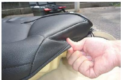
9 カバー側面後方に付いてるマジックテープを、直接シートに貼り付けて固定します。
