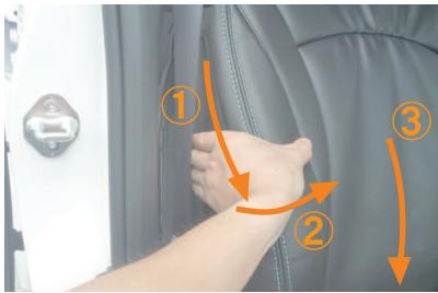
7 シート側面の生地を①→②→③の手順でシートに馴染めます。シート側面のしわが消えるまで繰り返し行って下さい。
