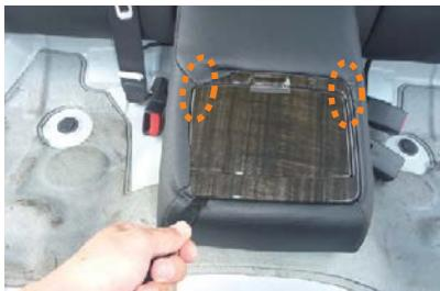
7 ドリンクホルダーのフチに生地を入れ込みます。○で囲んでいる部分は隙間が大変狭いので、作業は慎重に行って下さい。
