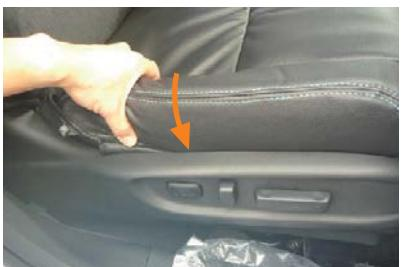
8 シート外側面のシートとプラスチック部のフチに、生地を入れ込みます。
