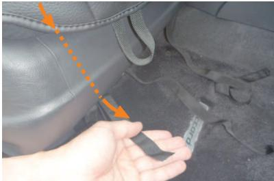
14 カバー前方に付いているベルトをシートとプラスチック部の隙間を通してシート裏から引き出します。ベルトはシート裏を通して、シートの背面へ回します。
