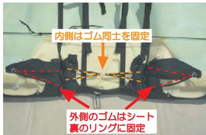
15 12ページ7番で入れ込んだ生地に付いているゴムに、S字フックを取り付けて固定します。内側のゴムはゴム同士をS字フックでつないで固定し、外側のゴムはS字フックをシート表皮を固定しているリングに引っ掛けで固定します。
