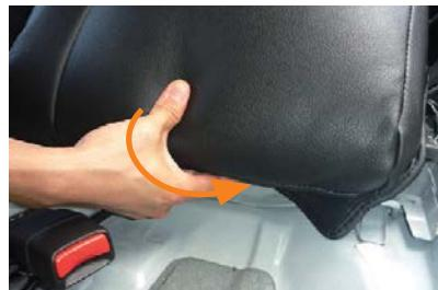
16 シート下に生地を巻き付けるように、マジックテープで直接シートに貼り付けて固定します。
