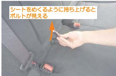
1 2列目座面はシートを車体から外してカバーの取り付けを行います。始めにアームレスト下あたりの、背もたれと座面の隙間の奥にあるシートを固定しているボルトを、ソケットレンチを使用して外します。
