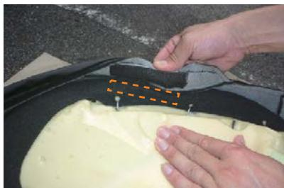
11 カバー側面下に付いているマジックテープを、直接シートに貼り付けて固定します。
