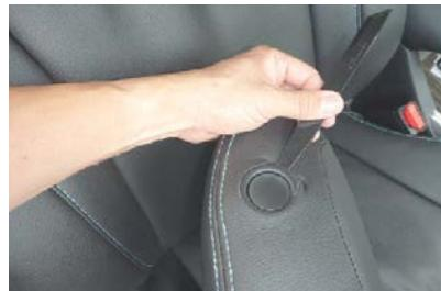
6 ヘッドレスト側面のボタン部分に、ヘラなどを使用して生地を入れ込みます。
