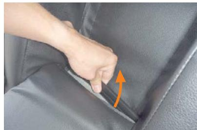
4 アームレストを倒して端にフックの付いた生地を引き出します。
