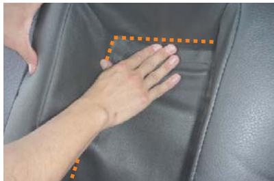
15 アームレスト収納部の生地を、しわが寄らないようにしっかりと馴染ませながら、マジックテープで直接シートに貼り付けて固定します。
