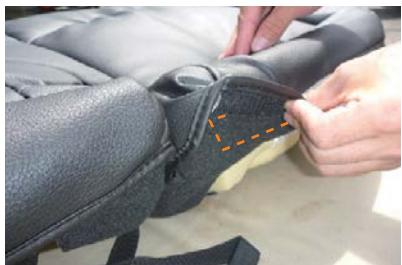
8 カバー後方に付いているマジックテープを直接シートに貼り付けて固定します。
