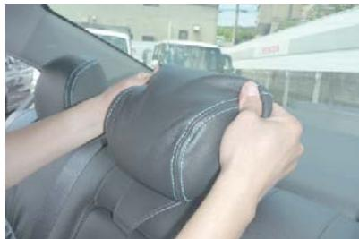
10 2列目中央のヘッドレストです。2列目中央ヘッドレストは図の矢印方向に、ヘッドレストのラインに合わせて下から上へかぶせます。カバーは平らなプラスチックが付いている方が前です。
