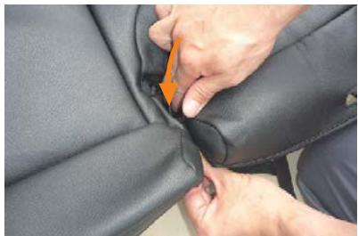
7 シートベルトバックルが出ているフチに生地を入れ込み、シートの形状に生地を馴染ませます。
