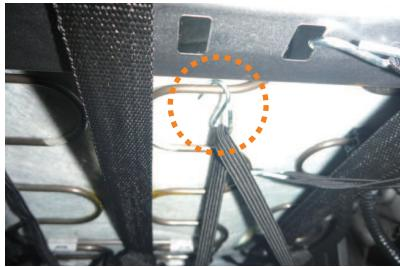
12 S字フックをシート裏の金属部分に引っ掛け固定します。
