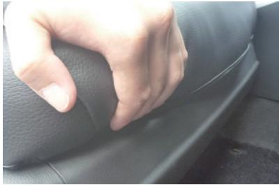
15 カバー前方の生地を、シートとプラスチック部の隙間に入れ込みます。
