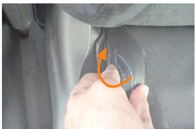
9 シート外側面の付け根部分です。シートのラインに沿わせて生地を入れ込み、生地裏のマジックテープを、直接シートに貼り付けて固定します。
