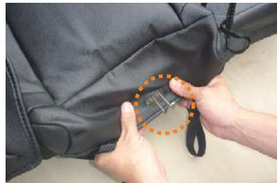
6 1番で外したボルトで固定していたフックにカバーの加工穴を通します。
