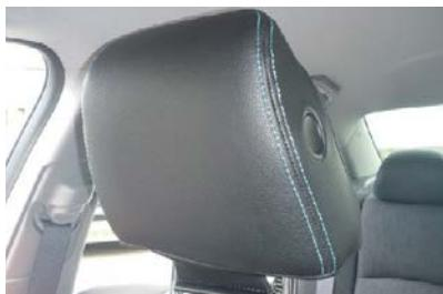
2 ヘッドレストのラインからずれないようにカバーをヘッドレスト全体にかぶせます。この際、ヘッドレスト側面のボタン部分にカバーの穴位置を合わせます。
