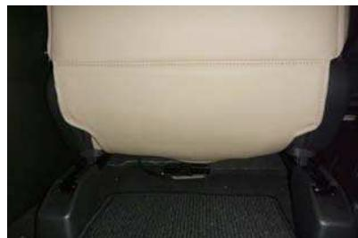
11 金属フックをシート底面の金属部に引っ掛け固定します。
