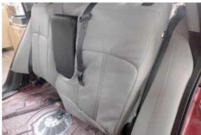
4 アームレストを斜めに倒してカバーの加工穴に通します。シート全体にカバーをかぶせます。
