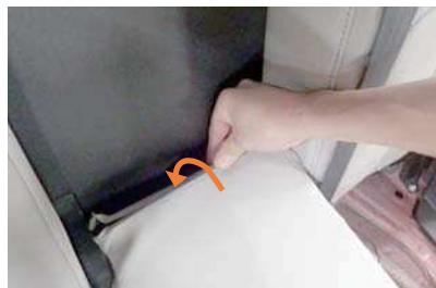
5 アームレストを倒した状態で、アームレストの付け根部分でプラフックを固定します。
