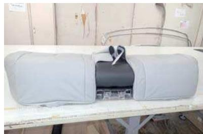
9 ロックを解除してシートを持ち上げると、フックが外れます。運転席側・助手席側それぞれフックを外すと、シートが車体から外れます。
