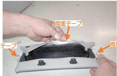
4 カバーの固定方法には薄手の両面テープの 使用を推奨します。
