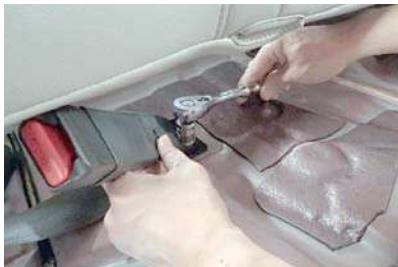
24 中央のシートベルトバックルを固定します。
