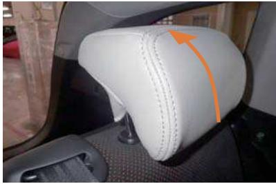
8 2列目の両端・中央のヘッドレストは、ヘッドレストの先端から後ろ側へカバーをかぶせていきます。
