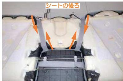
22 トレイの後ろから出ているマジックテープはシートの後ろ側から出ているマジックテープと固定します。
