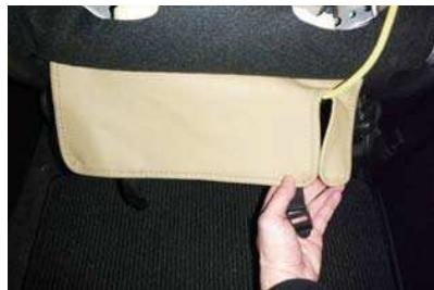
4 入れ込んだ生地を、後ろ側から引き出します。引き出す際に、図のように配線をかわすようにして下さい。
