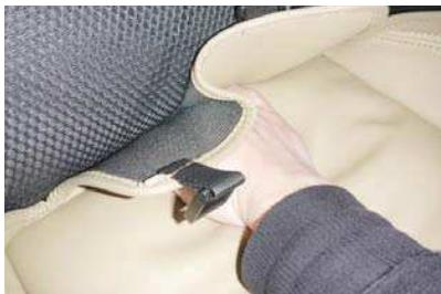
3 背もたれと座面の隙間に生地を入れ込みます。背もたれの角度を調整して、入れ込みやすい位置で行って下さい。
