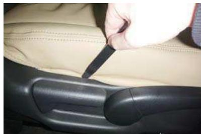
6 カバー外側面の生地をシートとプラスチク部の隙間に入れ込みます。
