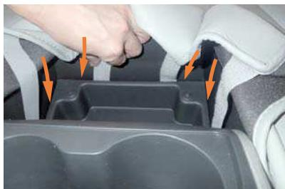
14 シート中央の反転テーブルを出します。反転テーブルを出すと、奥に小物を入れたりするようなトレーがあります。そのトレーとシートの隙間に、マジックテープを4本とも図のように入れ込んでいきます。
