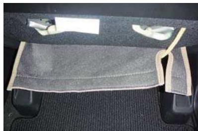
5 入れ込んだ生地を、後ろ側から引き出します。引き出す際に、図のように配線をかわすようにして下さい。
