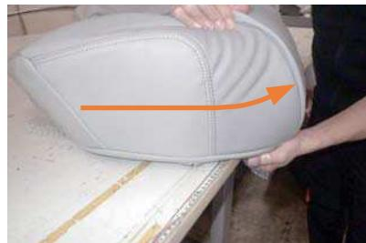
10 カバーをシートの側面から中央に向けてかぶせていきます。シートのラインを意識して作業を行って下さい。
