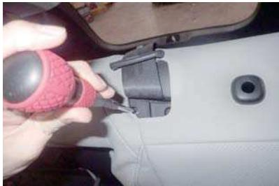
17 中央のシートベルトが出ているプラスチックパーツのフチに生地を入れ込みます。プラスチックパーツはシートの表側にネジ2本で固定されています。ドライバーを使用してネジを緩めます。ネジは外さず緩めるだけで十分です。
