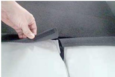
25 ラゲッジボードを戻した際、カバーの端に付いているマジックテープに、ラゲッジボードの端に付いているマジックテープを固定します。
