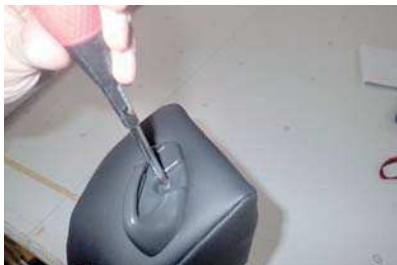
5 カバーを装着する前にシートベルトガイドを外します。ガイドはネジで固定されています。ドライバーを使用してネジを外すとサイドパーツからガイドが外れます。
