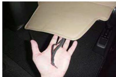
10 カバー背面に付いているゴムに、付属の金属フックを取り付けます。
