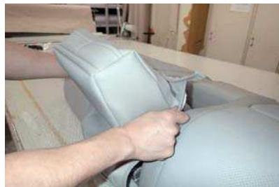
1 反転テーブルを図のように斜めに立てた状態でカバーをかぶせます。
