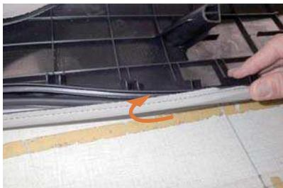
13 純正シート地のプラフックを外したフチにシートカバーのプラフックを固定していきます。
