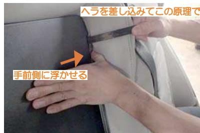
9 アームレスト収納部の内側に生地を入れ込みます。端に固定部材の付いた生地をヘラなどを使用して入れ込みます。この際、図のプラスチックパーツを手前に引きながら作業を行うと固定部材が入り込みやすくなります。
