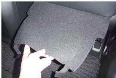
1 始めに、シート後ろ側から底面を覆っている生地を取り外します。生地はシート底面の金属部に、フックで固定されていますのでフックを外して下さい。
