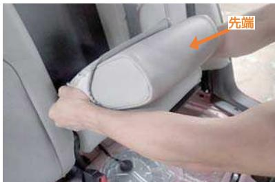
1 カバーを図のように裏返し、アームレストのラインに合わせてカバーをかぶせます。この際、アームレストの先端まで生地が張るようにしっかりととかぶせて下さい。
