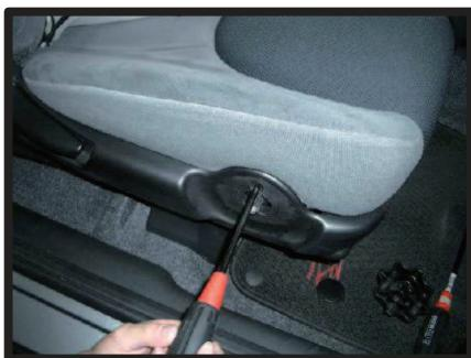
③ダイヤルを外すと、図の位置にネジがありますので、ドライバーでネジを外します。
