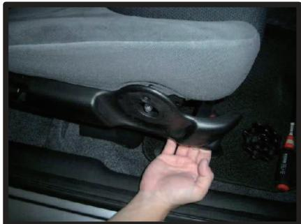
④ネジを外すと、図のようにシート側面のプラスチックカバーが一部外せるようになります。
