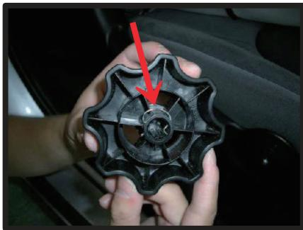
②図の赤い矢印部分にあるピンを外すと、ダイヤルをシートリフターの軸から引き抜く事が出来ます。
