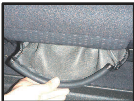
⑨⑧で入れ込んだ生地を背もたれ背面から引き出します。
