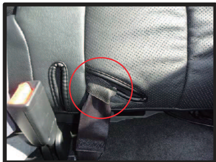
㉒ 7 ページ①で外したシートベルトバックルは、カバーに付いているゴムに固定します。
