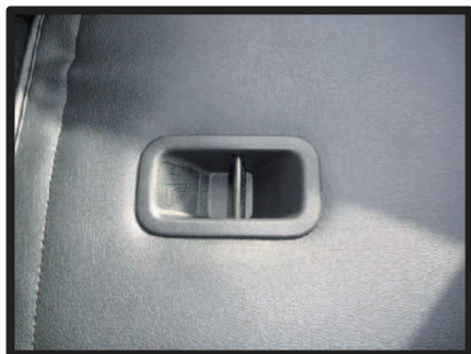
⑳ シート背面のチャイルドシート固定用フック部にも、同様に生地を入れ込みます。隙間が狭いので少しずつ慎重に作業して下さい。
