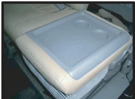
⑦背もたれのカバーをかぶせます。テーブル部分の隙間にカバーを入れ込み、固定します。
