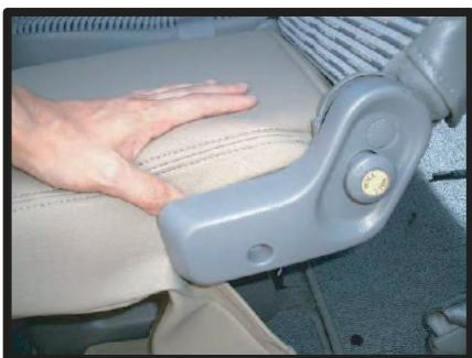
⑥シートカバーをかぶせて⑤で外したプラスチックカバーの隙間に入れ込みます。座面裏側にマジックテープで固定します。
