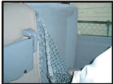
①背もたれカバーを取り付ける前に+ドライバーで背面のネットを取り外します。
