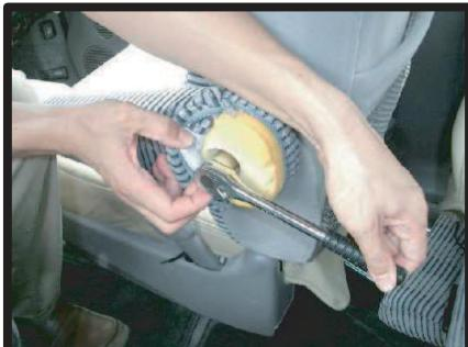
①アームレストを取り外します。ファスナーを開き、ソケットレンチでナットを外します。
