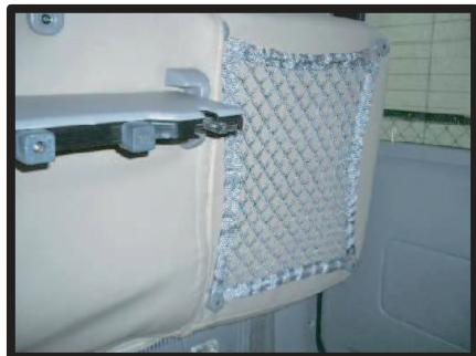
②1列目と同様にシートカバーを取り付けます。ネジ穴の位置に穴をあけてネットを元通りに取り付けます。
