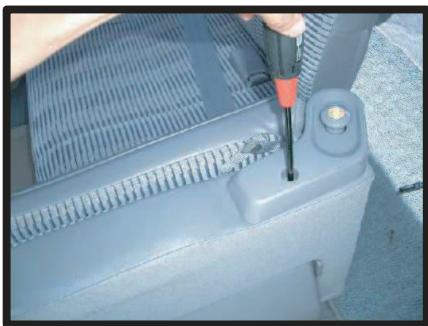
⑤補助席のカバーをかぶせます。座面外側のプラスチックカバーのネジを+ドライバーで外します。
