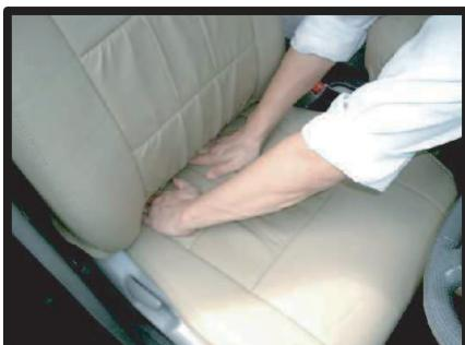
③側面のしわを中央に寄せるようにしてシートとカバーをなじませます。座面と背もたれの間にカバーを入れ込み、裏側から引き出してからマジックテープで固定します。
