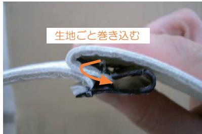
4 プラフックの固定方法は、カギ状のプラフックに板状のプラフックを、生地ごと巻き込むようにめ込み固定します。
