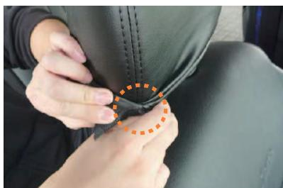
2 カバーを左右均等に引き下げていきます。図の○位置にカバーをかぶせる際は、生地を破らないよう、慎重に作業を行って下さい。
