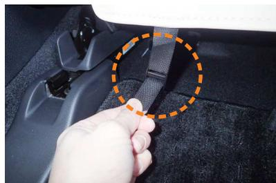
10 3番で引き出した生地についているバックルに、9番でシートの後ろ側から引き出したベルトを通し、固定します。
