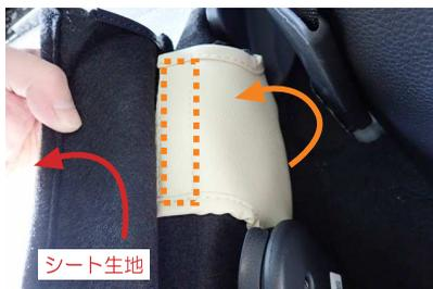
21 背面のシート生地をめくり上げ、20番で通した生地を、マジックテープで直接シートに貼り付け固定します。
