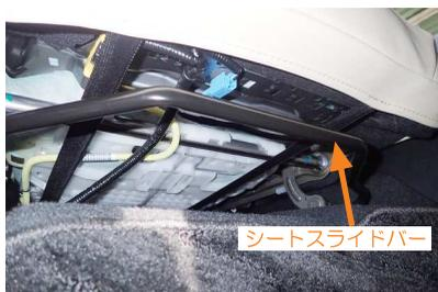
9 カバー前側に付いているベルトを、シートスライドバーの上側を通して、後ろ側へ引き出します。
