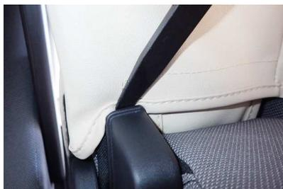
19 アームレストのヒンジ部（プラスチックパーツ）の隙間に生地を入れ込みます。
