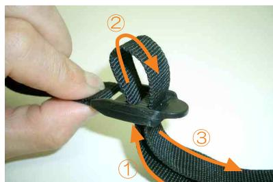
11 ベルトは、図の①～③の順にバックルを通し、通したベルトを引く事で前後に締まりカバーが固定されます。
