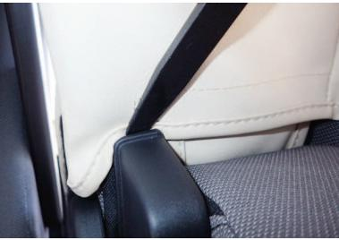
19 アームレストのヒンジ部（プラスチックバーツ）の隙間に生地を入れ込みます。
