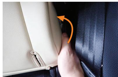
20 外側面下部の生地をシートを覆うようにして、後ろ側へ通します。
