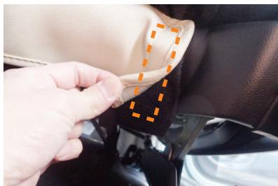
3 2番で入れ込んだ生地を、後ろ側から引き出し、生地に付いているマジックテープをシートに直接貼り付け固定します。
