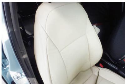
1 カバー背面に付いているファスナーを開いた状態で、シートのラインに合わせてカバーをかぶせます。
