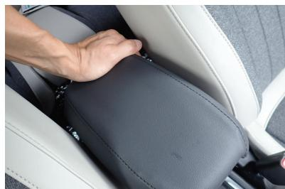
8 アームレストの後ろ側を押さえて土台に固定します。
