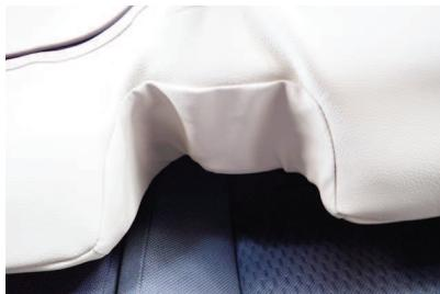
7 シートベルトバックル位置の形状に沿うようにカバーを馴染めます。
