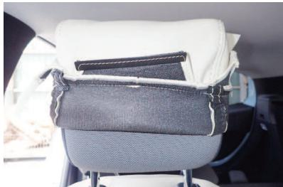
1 カバーの前後を確認します。板状のプラスチックパーツが付いている方が前側です。カバーを裏返してヘッドレストのラインに合わせてかぶせます。この際ヘッドレストの先端まで生地が張るように、しっかりとかぶせます。
