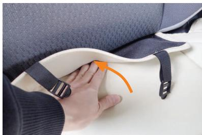
2 背もたれと座面の隙間に生地を入れ込みます。背もたれの角度を調整して、入れ込みやすい角度で作業を行って下さい。
