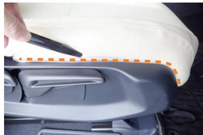
4 外側面の生地（図の点線部）をシートのプラスチック部の隙間に入れ込みます。
