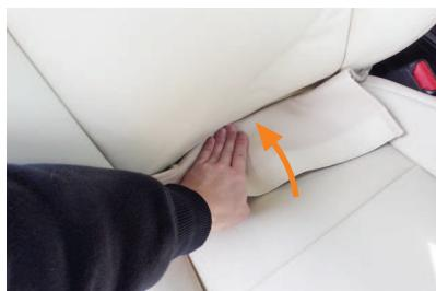
6 背もたれと座面の隙間に生地を入れ込みます。背もたれの角度を調整して、入れ込みやすい角度で作業を行って下さい。
