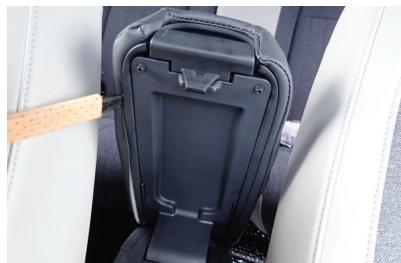
7 カバー側面の生地を土台との隙間に付属のヘラを使って入れ込みます。両面テープ等で側面の生地を固定している場合は、この作業は不要です。
