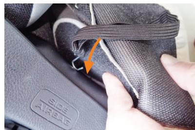
6 5番で金属フックを付けたゴムを、シートの隙間に入れ込みます。
