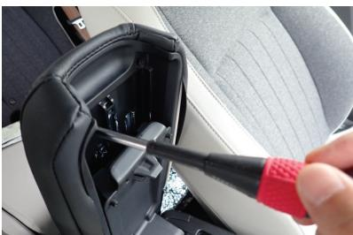
6 カバー前側の生地を内側に折り込みながら土台部分にはめ込み、1番で外したネジを締め直します。
