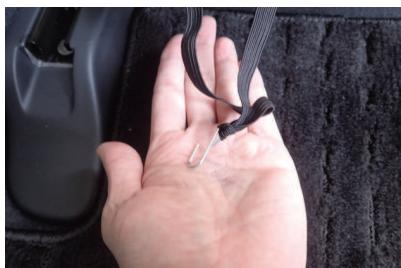
9 カバー背面下の生地に付いているゴムに、付属の金属フックを取り付け、シート底面に固定します。
