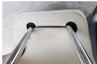
10 ヘッドレストをシートから外し、ヘッドレスト裏で、1列目と同様にプラスチックパーツでカバーを固定します。
