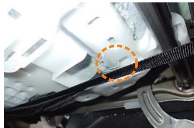
10 シート底面は図のようになっています。○位置のように、くぼみがある箇所に金属フックを引っ掛け固定します。
