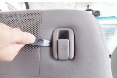
**14** コンビニフックを取り外します。コンビニフックとシートの隙間にヘラを差し込み、ヘラをひねる事でコンビニフックが外れます。詳しい説明、ツメの形状は**15番**をご覧下さい。
