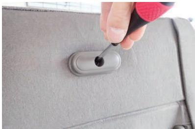
1 シートを跳ね上げて、シート裏に付いているプラスチックパーツをドライバーを使用して外します。
