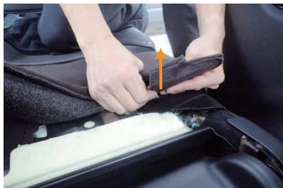
3 次に、純正表皮がシートのフレームにピンで固定されている為、ピンを真上に引き抜き固定を外します。
