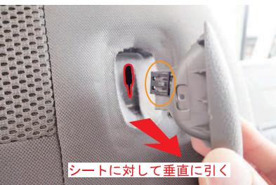
**15** ツメは図のような形状になっています。図の○部分のツメで固定されている為、ツメをシートに対して垂直に引き抜くイメージで行って下さい。※引き抜く際、荷物を掛けるフック部分は引かないようにして下さい。
