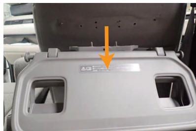
4 ボルトを外し、テーブルを手前に引くようにするとシートからテーブルが外せます。※外したテーブルは傷つけないよう、注意して下さい。
