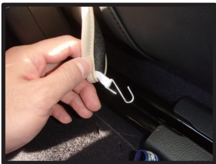
⑨運転席側カバーの内側面にはゴムが付いています。ゴムに付属のS字フックを引っ掛けます。
