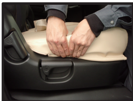
⑧カバー側面のフチをシートのプラスチック部分に入れ込みます。座面の付け根部分はシートにマジックテープで直接固定します。
