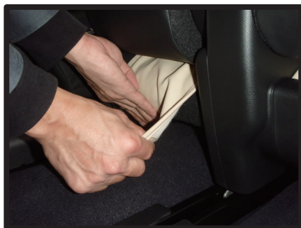
⑦アームレスト下から入れ込んだ生地は、シート背面から引き出してシートの裏側にマジックテープで直接固定します。
