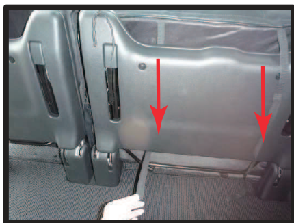
⑨ベルトを座面とシート台座（図のプラスチック部）の隙間を通し、カバー前側のバックルで固定します。
