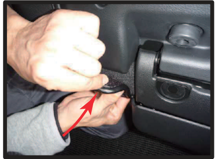
⑦ 底面の前方の生地も、マジックテープで固定します。
