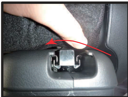
⑪沿わせたヒモは、座面後ろ側で、図のようにシートレールの上部に引っ掛けます。
