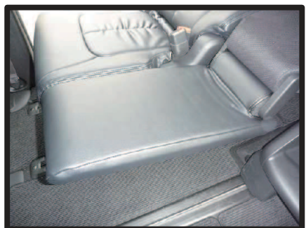
⑨ カバーのラインを整え、2列目補助席座面の完成です。
