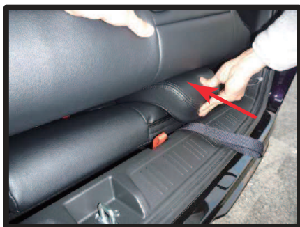
③床下格納時に、ヘッドレストが干渉する時は、図のようにヘッドレストを背もたれ側に押さえます。
