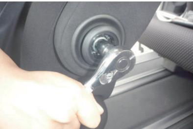
2 ソケットレンチ（14mm）等を使用してボルトを外します。
