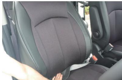
6 背もたれと座面の隙間に生地を入れ込みます。背もたれの角度を調整して入れ込みやすい位置で行って下さい。
