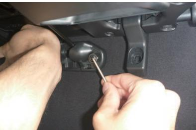
3 背もたれ背面のシートバックテーブルを外します。テーブルを起こし、背面のボルトを六角レンチ（4mm）を使用して外します。
