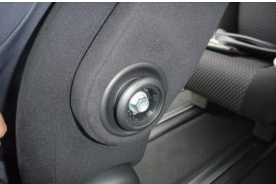
1 先端の細い物を差し込み、アームレスト側面のキャップを外します。
