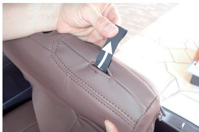
3 シートの先端にあるリクライニング用ベルトをカバーの加工穴から取り出します。
