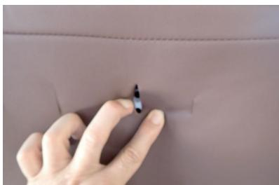
23 テーブルを固定するボルトの穴位置にカバーの切れ込みを入れています。（6箇所）
