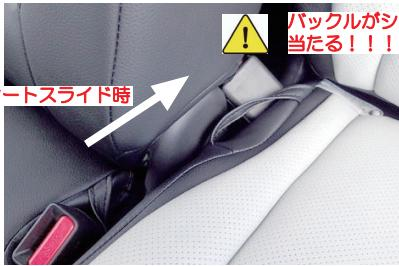
24 シートベルトのバックルが、ベルトから抜き出た状態で使用していると、シートをスライド時に、図のようにバックルがシートに当たり、最悪の場合破損する可能性があります。
