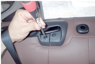
39 ネジをドライバーを使用して固定します。
