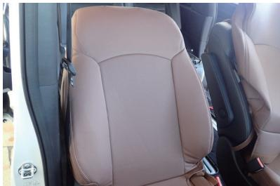
7 カバー側面のファスナーを開けておきます。カバーをシートのラインに合わせてシート全体にかぶせます。
