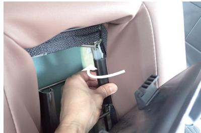
22 アームレスト収納部両端のカバーに固定部材のフックが付いています。
