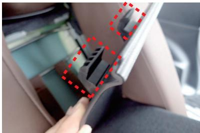
31 プラスチックパートを元通りに固定します。プラスチックパートの裏側のツメの位置を確認して、ツメを引っ掛けることを意識して元に戻します。
