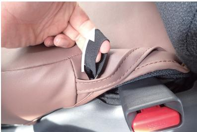
13 2番でシートベルトのバックルを抜き出したゴムを、カバーの加工穴に通して引き出します。
