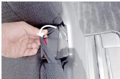
1 シートベルトのバックルを、固定しているシート地のベルトから抜き出します。
