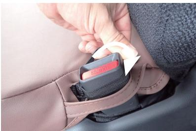
14 シートベルトのバックルに図のカバーに付いているベルトと13番で引き出したゴムを通します。
