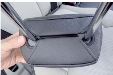
5 ヘッドレストの裏側で1列目ヘッドレストと同様にプラスチックパーツを固定します。
