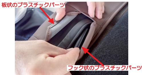
14 シート背面のシートを格納状態から持ち上げる際に使用するベルト部分です。
