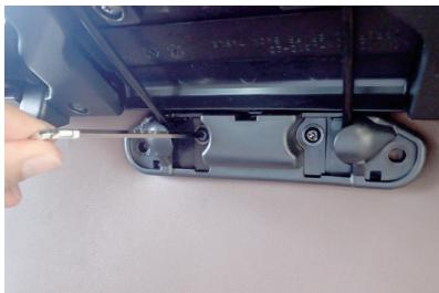
**25** 中央2か所のボルトを仮止めして、全てのボルトを均等に固定していきます。
