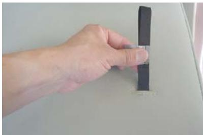
9 助手席側の背もたれは、カバー背面の切り込みからシートスライド用のベルトを引き出します。
