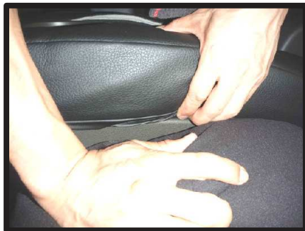
⑯ カバー内側面の生地を、座面内側面のプラスチック部に入れ込みます。
