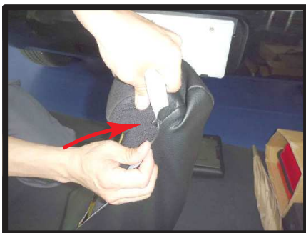
⑪アームレスト前方側は、生地伸びを利用してかぶせます。 ※図の矢印位置に力が掛かり過ぎると縫い合わせ部分が裂ける恐れがありますので、作業は慎重に行ってください。
