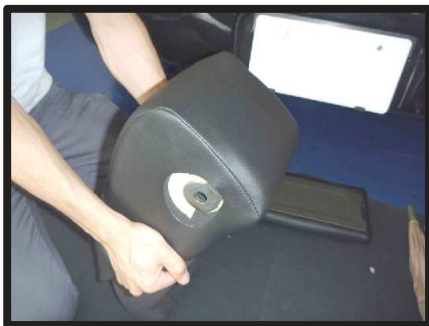
⑩アームレスト本体にカバーをかぶせます。アームレスト後方側から図のようにかぶせます。
