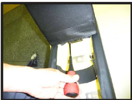
⑫上フタを本体に固定します。ネジはしっかりと締めて下さい。上フタの固定がずれると、上フタのロックがかりづらくなります。
