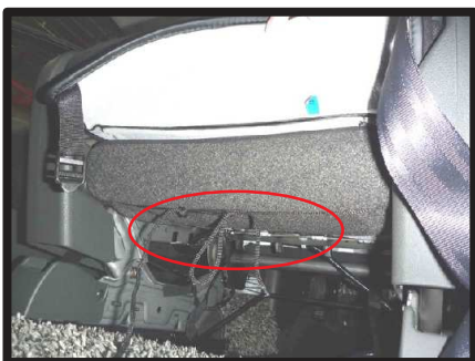
⑮ 1 ページ⑥と 2 ページ⑨で引き出したヒモを、図のように座面裏で引き絞り固定します。
