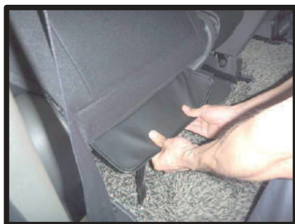
⑤③で入れ込んだ生地を、後ろ側へ引き出し、②で引き出したベルトで固定します。
