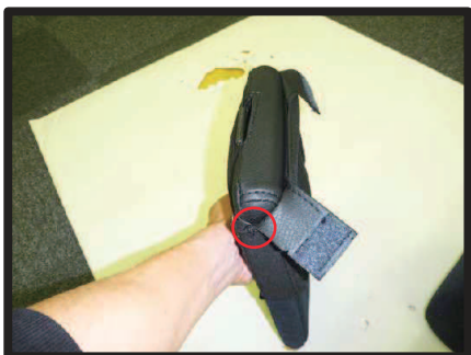
⑤上フタにカバーをかぶせます。 カバーを半分程まで裏返して上フタの先端までしっかりとかぶせます。この際、図の丸印部分（縫い合わせの境目）に負荷がかかりすぎると生地が裂ける恐れがありますので、作業は慎重に行ってください。
