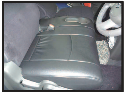
⑳ カバーのラインを整え、1 列目運転席座面の完成です。
