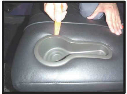
⑰ 座面のカップホルダー一部に、ヘラ等を使い、生地を入れ込みます。
