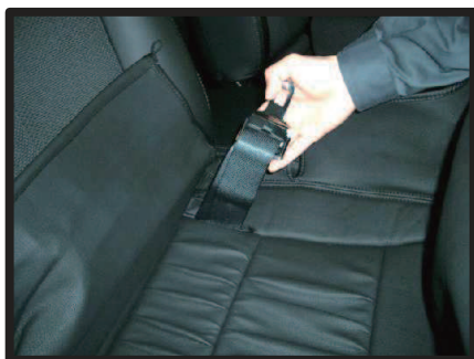
②カバーの切れ込みからシートベルトを取り出します。
