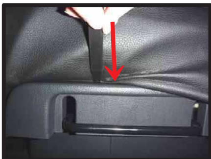
⑪外側面の生地も同様にプラスチック部の隙間に入れ込みます。 ※隙間が広い為、奥までしっかり生地を入れ込んでください。
