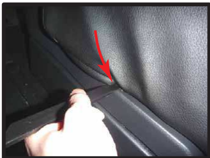
⑩内側面の生地をシートのプラスチック部の隙間に入れ込みます。
