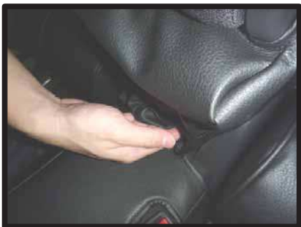
⑫背もたれと座面の隙間に生地を入れ込みます。
