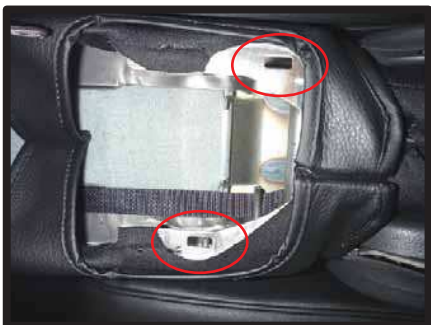
⑪プラフック固定後に、図の○部に生地がかぶらないようにして下さい。
