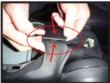
⑩カバー背面のプラフックが付いている生地を固定します。
