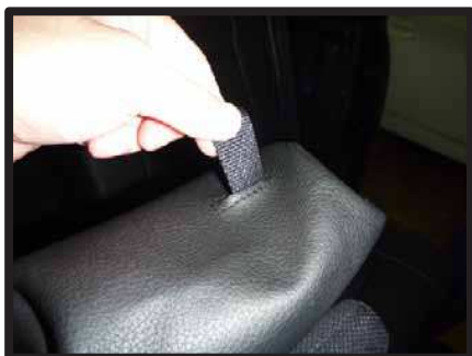
⑧カバー上側の加工穴からは、シートリクライニング用ストラップを取り出します。
