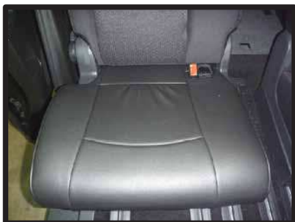
⑧カバーのラインを整え、2列目運転席側座面の完成です。
