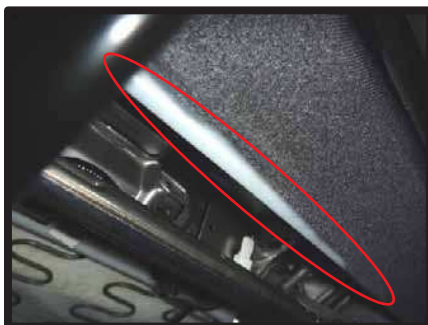
⑤シートの前側から底面を見ると、図のようにシート本体の生地がプラフックで固定されています。
