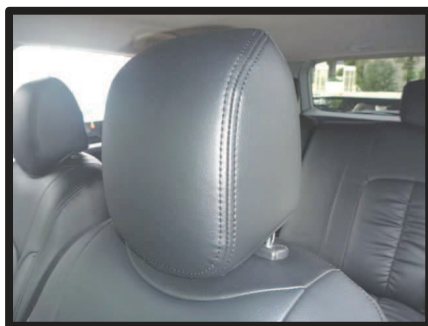
⑨ヘッドレストのラインとずれていないか確認して、ヘッドレストを背もたれへ戻し1列目ヘッドレストの完成です。 ※2列目ヘッドレストも同様に取り付けます。
