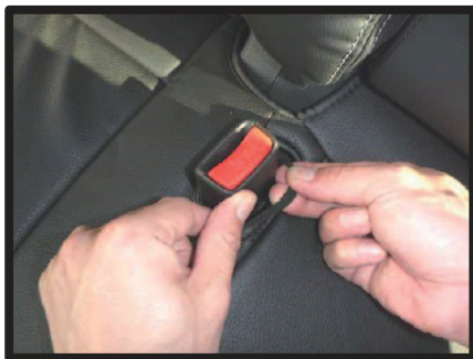
⑯シート中央にあるシートベルトバックルをカバーの加工穴から引き出し、加工穴に付いているゴムを、図のようにバックルの根元までかぶせます。
