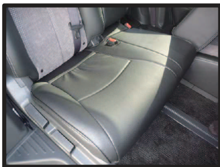
⑯カバーのラインを整え、2列目運転席側座面の完成です。助手席側は一部形状が異なりますが同様に取り付け、最後に12ページを参照します。
