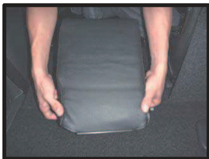
⑨ アームレストのラインからずれないようにカバーを全体にかぶせます。
