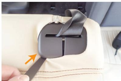
5 中央席用のシートベルトの台座の隙間にも同様に生地を入れ込みます。
