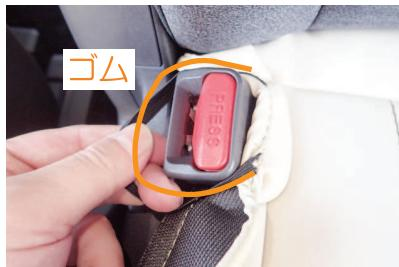
11 助手席側座面の内側面には、中央専用のシートベルトバックルが付いています。
