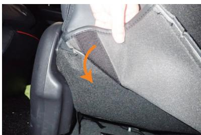
11 カバー背面に付いているマジックテープをシートに直接貼り付け固定します。
