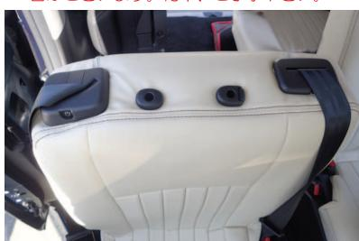
6 カバーの加工穴から生地の伸びを利用してヘッドレストの台座を取り出します。
