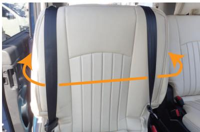
1 カバー背面の2箇所のファスナーを開き、シートベルトの内側を通して、シート全体にカバーをかぶせます。
