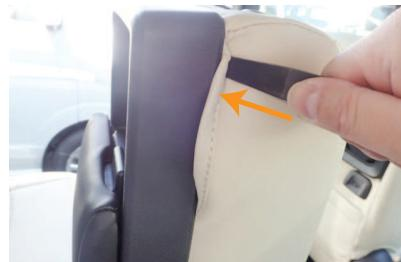
13 ボックス部を戻した後に、はみ出た生地をヘラ等を使用して、隙間に入れ込みます。
