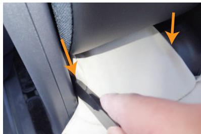
4 シートの付け根部分の両側の生地を、シートとプラスチックカバーの隙間に入れ込みます。ヘラ等を使用して、奥の方まで生地を入れ込んで下さい。
