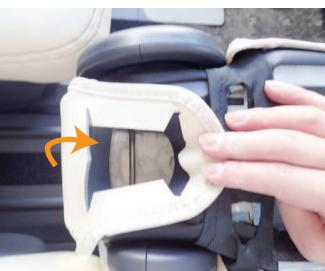
11 7番で引き出した生地を、シート形状に沿ってかぶせます。この際、カバーの加工穴の位置が、3番のツメの固定位置（図の○位置）と合っている事を確認して下さい。生地を挟み込むようにして、ボックス部を元に戻します。
