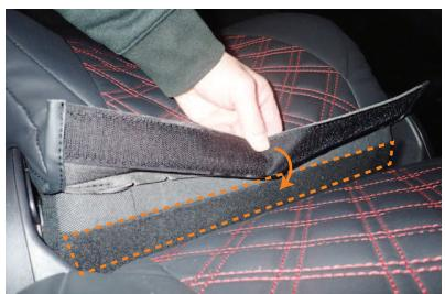
8 シートを後ろに倒した状態で、カバーの端に付いているマジックテープを、シートに直接貼り付け固定します。
