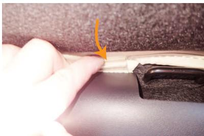
8 取り出した固定部材は、シートとプラスチックカバーの隙間に込み固定します。
