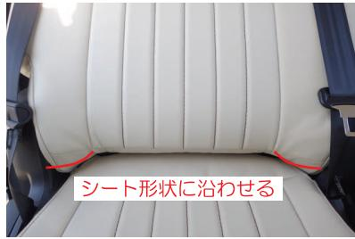
11 マジックテープの固定後に、シートを後ろに倒した状態で、両端に引き出した生地がシート形状に沿っている事を確認して下さい。
