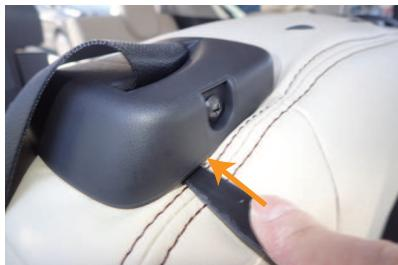
4 シートベルトの台座とシートの隙間に生地を入れ込みます。
