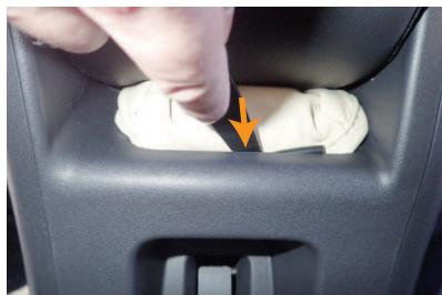
5 3番で引き出した生地を付いている固定部材を、シートとプラスチックカバーの隙間に入れ込みます。ヘラ等を使用して、奥の方まで生地を入れ込んで下さい。
