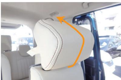
1 カバーの前後を確認し、ヘッドレストの前側から後ろ側方向にカバーをかぶせます。板状のプラスチックパーツが付いている方が前です。
