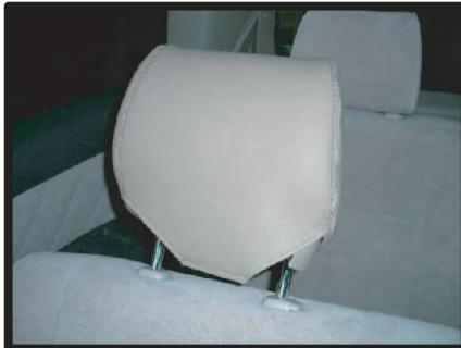
③ヘッドレスト全体にカバーをかぶせて、位置を調整します。カバーをヘッドレストになじませるようにしてラインを合わせていきます。
