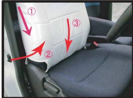
④側面のしわを中央に寄せるようにしてシートとカバーをなじませます。座面と背もたれの間にカバーを入れ込み、裏側から引き出します。
