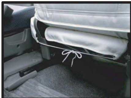
⑭カバー側面から出ているヒモは、片側のヒモで輪を作り、もう片側のヒモをその輪に通します。通したヒモを引っ張り、絞り込んで結びます。
