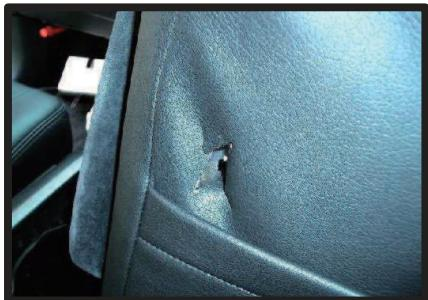
②背もたれカバーを取り付けます。シート本体とカバーがズレていないかをよく確認した上で、フックの位置に切り込みをいれます。
