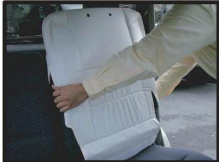
①純正のシートのラインに合わせて背面にかぶせ、カバー前側の生地を、背面と座面の間に入れ込みます。
