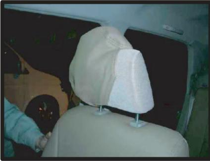
①ヘッドレストカバーの前後を確認してからかぶせます。平らなプラスチックの部品が付いているほうが前です。図のようにヘッドレストの端に引っ掛けるようにします。
