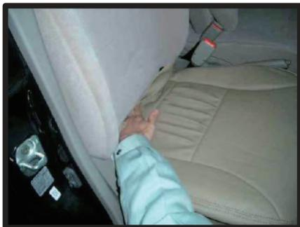
①運転席の座面カバーをシートのラインに合わせてかぶせます。座面と背もたれの間にかバーを入れ込んで後ろから引き出します。
