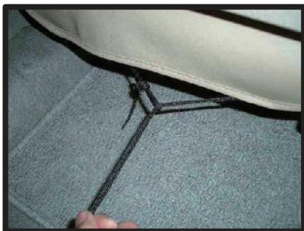
③座面後ろ側に紐を取り出し、固定します。片側の紐で輪を作り、反対側の紐を通して絞り込んでから結びます。
