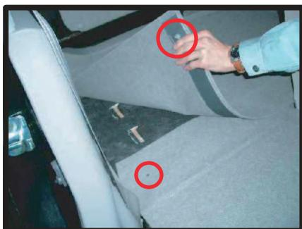
⑥背もたれカバーをかぶせる前に背もたれとトランクをつなぐカーペットを外します。ピンで留まっている部分を引っ張ると外れます。
