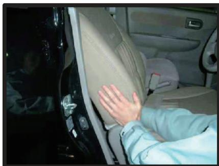
②側面のしわを中央に寄せるようにしてシートとカバーをなじませます。
