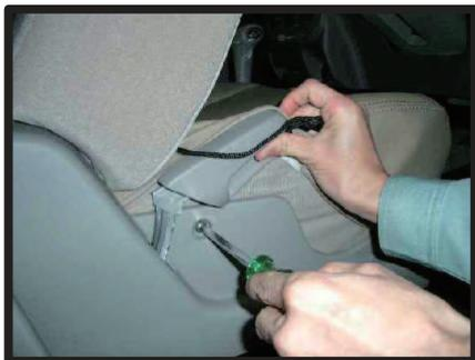
②側面のプラスチックカバーの隙間にシートカバーを入れ込みます。リクライニングレバー裏側のネジを外して紐を後ろから引き出せるようにします。
