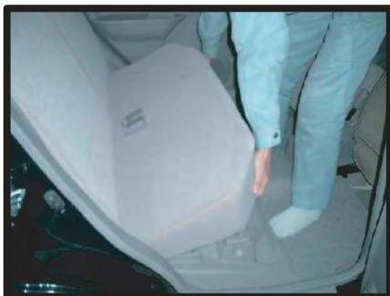
①座面カバーをかぶせる前に座面を取り外します。座面前側の左右を持ち上げると、固定されているフックが外れます。
