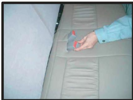
④座面を元の位置に合わせてからシートベルトを穴から取り出しておきます。
