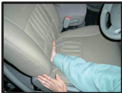
③座面と背もたれの間マジックテープの付いた部分を入れ込み、後ろ側から引き出します。
