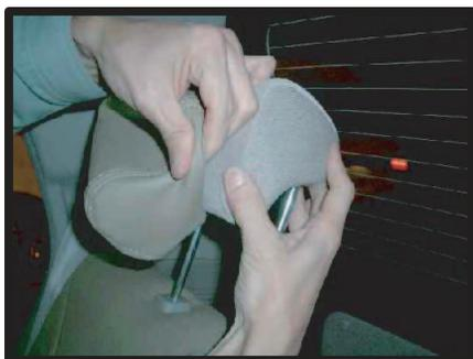
⑦2列目ヘッドレストカバーをかぶせます。前側からもぐり込ますように入れ込み、カバー全体の位置を調整します。
