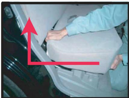
②図のように座面を押し込みながら後端を引き上げると座面が全部外れます。
