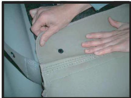
⑪⑥で外したトランク側のカーペットをシートカバーを挟んでから固定し直します。シートカバーの穴の位置を合わせてピンで留めます。
