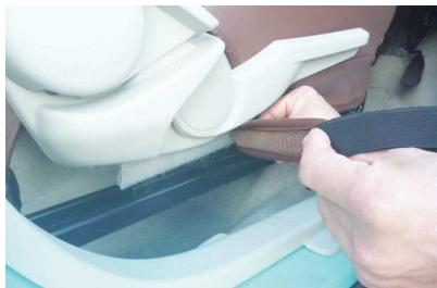
7 5Pの3番でかわした部分にマジックテープが付いているので、直接シートに貼り付けて固定します。
