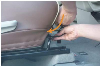
10 カバーの前側に付いているベルトをシート裏に通します。この時シートのスライドバーの上側を通すようにして下さい。
