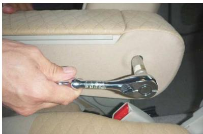
2 ソケットレンチなどを使用してボルトを外します。（ソケット12mm）
