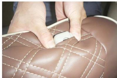
5 ヘッドレストの台座を取り出します。台座の片方のフチに生地をしっかりと入れ込みます。
