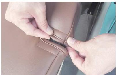
15 背面のシートを固定する金具をかわしてマジックテープを直接シートに貼り付け固定します。
