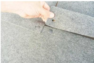
1 カバーを取り付ける前に2列目の背もたれ背面の生地がラゲッジボードにリベットピンで固定されているのでピンを抜くかピンの隙間から生地を外します。
