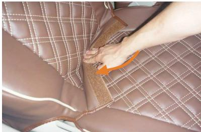
7 背もたれと座面の隙間に生地を入れ込みます。背もたれの角度を調整して入れ込みやすい位置で行って下さい。
