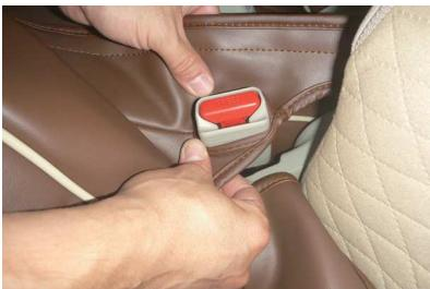
17 助手席側は始めにシートベルトバックルを加工穴に通します。シートの内側面の下側は、マジックテープを直接シートに貼り付けて固定します。
