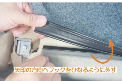
2 1番で外した生地をめくり上げ、シート表皮を固定している純正シート表皮のプラフックを外します。
