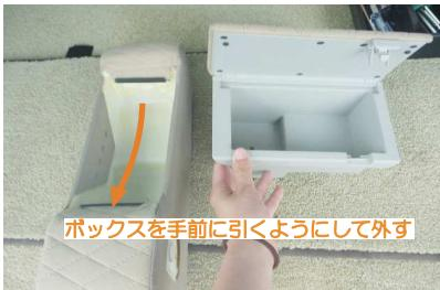
3 ボックスの裏にはツメが付いています。ボックスを矢印の方向へスライドさせるように外します。
