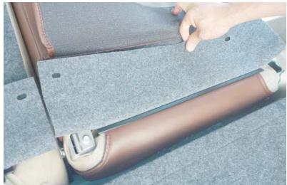
13 カバーの背面下を純正シート表皮のフックとカバーのプラフックで固定した図です。
