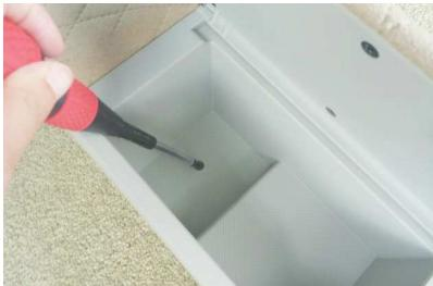
2 アームレストのボックスを外します。プラスドライバーでボックス内側のネジを外します。
