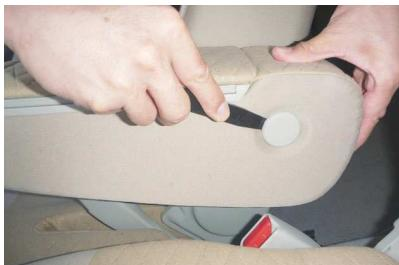
1 背もたれにカバーを取り付ける前にアームレストを取り外します。ヘラなどでアームレストのキャップを外します。
