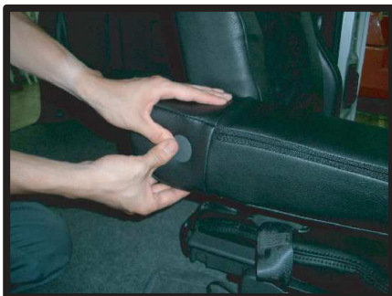
④プラスチックカバーを取り付け2列目アームレストの完成です。
