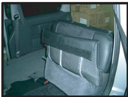
③カバーを半分ほど裏返してシートのラインに合わせてかぶせます。
