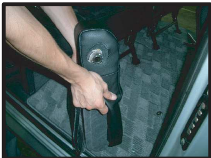
①カバーのファスナーを完全に開けた状態でカバーをかぶせます。
