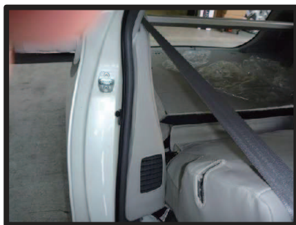
⑨サイドパーツ運転席側の完成です。 助手席側も一部形状は違いますが、 同様に取り付けます。
