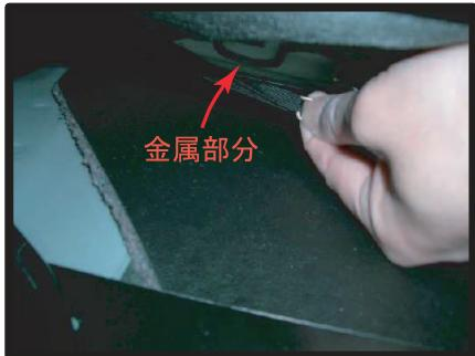
⑤座面を起こし、落としたS字フックを座面裏にある金属部分に引っ掛け、完成です。助手席側も同様にします。
