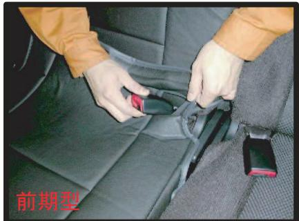
②カバーの穴にシートベルトを通します。（前期型のみ）背もたれと座面の隙間に生地を入れ込み、座面の奥で、直接シートにマジックテープで固定します。
