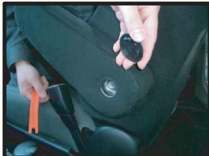
①へら等を使用して、アームレスト側面にあるプラキヤップを外します。
