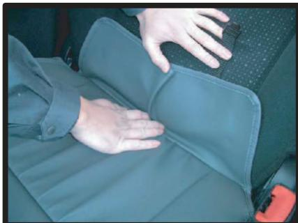
②背もたれと座面の隙間に生地を入れ込み、後ろ側から取り出します。
