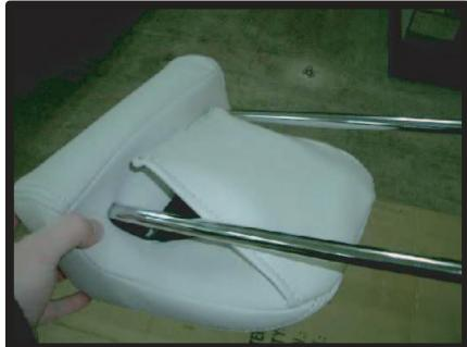
④カバーの下側をヘッドレストに引っ掛けるようにかぶせ、ラインを整えます。
