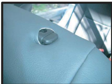
⑤ヘッドレストの台座部分を穴から取り出します。生地の伸びを利用して横から潜り込ませるように取り出します。
