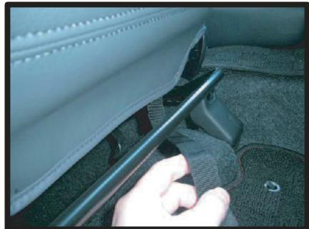
④カバー前部にあるベルトを座面の下を通し、後側へ引き出します。（図のように、シートスライドバーをかわして下さい。）
