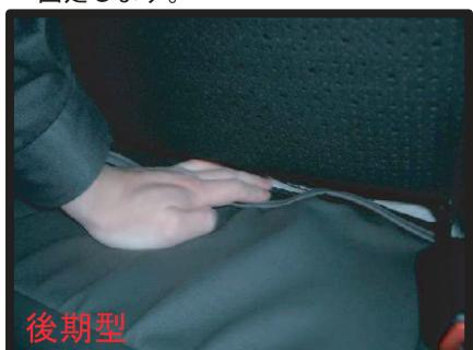
③背もたれと座面の隙間に生地を入れ込み、座面の奥で、直接シートにマジックテープで固定します。少し座面を起こすと作業がしやすくなります。
