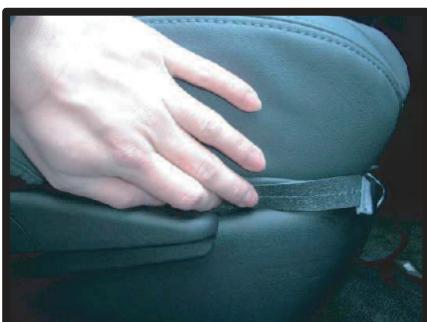
③座面側面のプラスチックカバーの中に、生地を入れ込みます。
