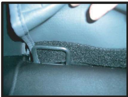
②背もたれと座面の隙間に生地を入れ込みます。図のように、チャイルドシート固定用フックをかわします。
