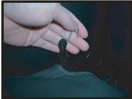
④カバーに付いているゴムには、図のようにS字フックを取り付け座面と車体の隙間に落とします。
