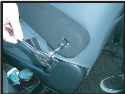
⑧アームレストを元通りに取り付けます。この時アームレストの突起と穴位置をしっかりと合わせてまっすぐにボルトを締めて下さい。位置がずれたまま締め付けるとシートを破損させる恐れがあります。
