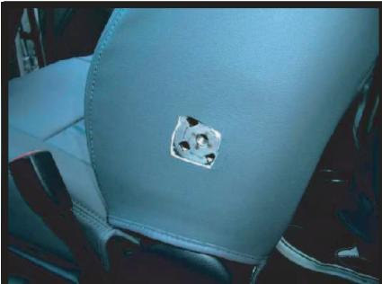
⑦背もたれカバーがきれいに取り付けられていることを確認した上で図のようにアームレスト取り付け部分のカバーを切り取ります。
