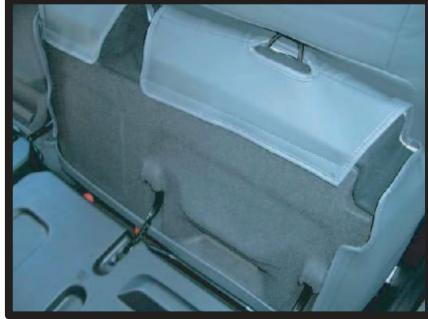
③座面を起こし、シートのラインを整えながらマジックテープで直接シートに固定し、2列目座面の完成です。助手席側も同様に取り付けます。
