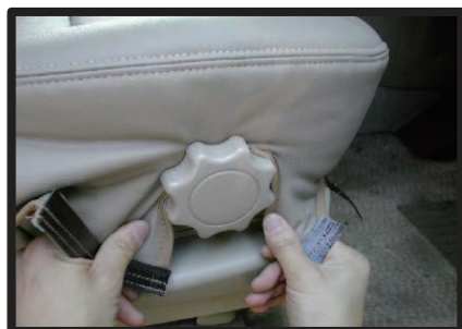
②ダイヤルをかわして側面をかぶせていきます。
