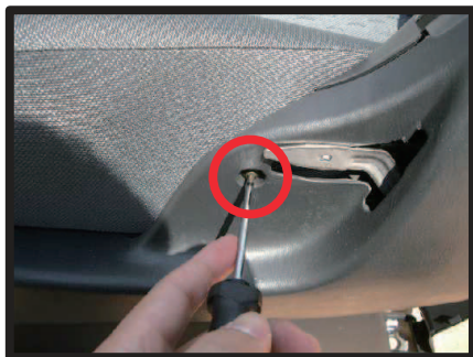
③プラスドライバーでカバーについているネジをはずします。
