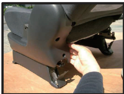
⑤ツメで固定されている部分があるので後ろ側から外していきます。
