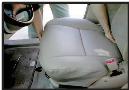
①座面カバーをシートのラインに合わせてかぶせます。
