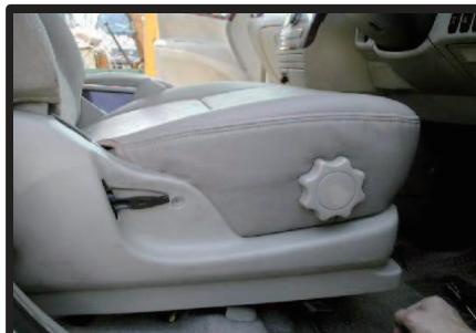
④側面のプラスチックカバーを元通りに取り付けます。
