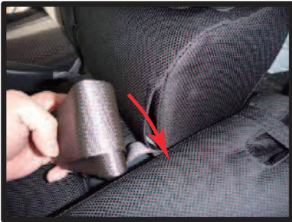
⑦アームレスト下側に収納されているシートベルトを取り出します。
