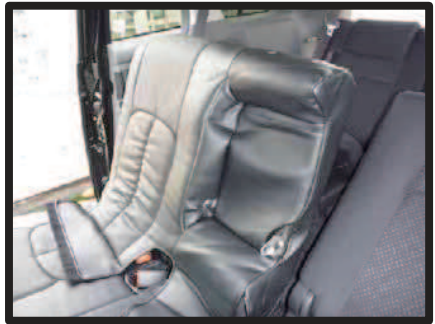
⑩ラインを整えながら、カバーを引き下げていきます。
