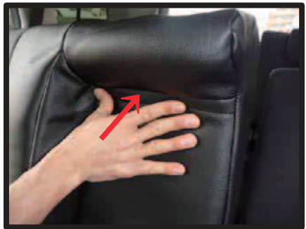
⑫カバーのアームレスト収納部の上端（図の矢印部）には、マジックテープが付いていますので、シートに直接固定します。
