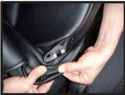
⑨アームレスト固定用金具は、カバーの加工穴から取り出します。
