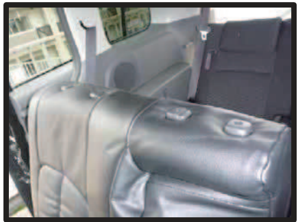
⑪ヘッドレストの台座部分を、1列目と同様に取り出します。
