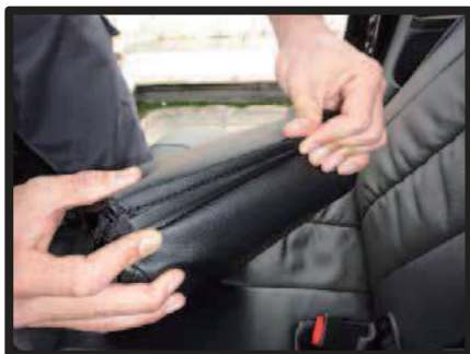
⑱カバー先端のプラスチックの部品を使用し、カバーを固定します。
