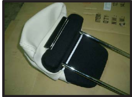
② カバーを上へずらして、ヘッドレストの上側からかぶせます。
