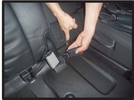
①シートベルトのバックルをゴムから外します。
