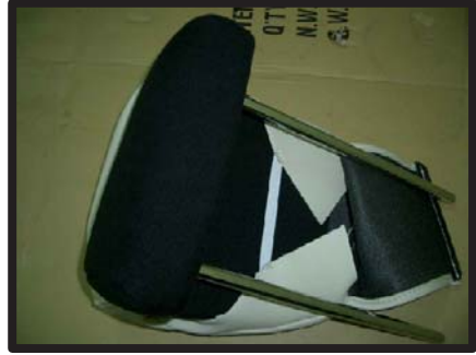
① カバーのゴムの付いた部分をヘッドレストに通します。
