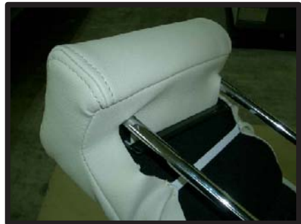
③ ヘッドレストの上側にカバーをかぶせ、ラインを整えます。
