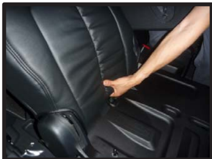
④座面を起こしカバー下の生地を背面に回します。
