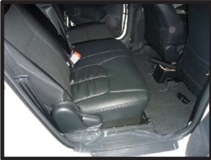
⑧2列目運転席側座面の完成です。 助手席側は形状が異なりますが、同様の固定方法で取り付けを行います。
