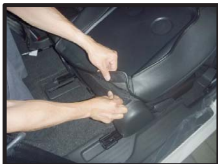
⑧⑤で引き出した生地と背もたれ背面をマジックテープで固定します。
