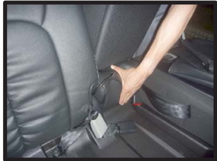
②カバーを下からもぐり込ませるようにかぶせていきます。
