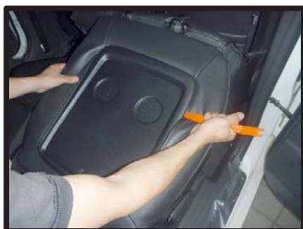
⑨背もたれ裏のバッグテーブルのフチに生地を入れ込みます。
