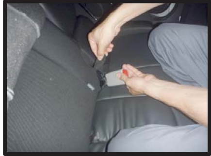
①始めにシートベルトのバックルをゴムから外します。
