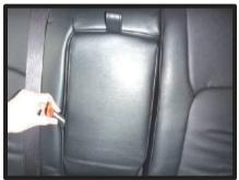
①アームレスト収納部のシワを無くしシートに早く馴染ませるためには、カバー取り付け後アームレストをしっかりシートに収納させへラ等で内部の生地を整えて一週間ほどそのままの状態を保っていただくと生地に型が付き、シワが解消されます。
