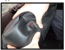
②リクライニングボタン、ヘッドレス トの台座をカバーの加工穴から取り 出します。
