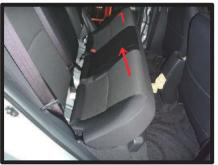
①2列目座面カバーはシートを車体から外して取り付けを行います。 シートは矢印位置の裏2ヵ所でフックて固定されていますので、矢印方向に持ち上げることで外れます。
