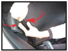
(B)助手席側は一部形状が異なります。 シート側面のファスナーは生地を内 へ寄せながら慎重に閉じます。固定 はシート背面で運転席側同様に、マ ジックテープで固定します。
