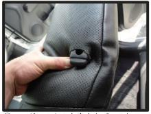
⑥ヘッドレストの台座をカバーの加工 穴から取り出します。まず台座のフ チに生地をしっかりと入れ込みます。
