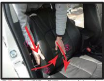
⑧①~③の手順で側面のシワをシート中央に寄せて、そのまま下になぞるようにカバーをシートに馴染ませていきます。シート側面のシワが無くなるまで続けて下さい。
