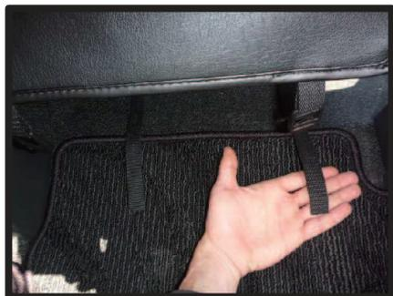
⑩シート背面からベルトを引き出します。ベルトは1ページの⑤で引き出した生地に付いているバックルと固定します。
