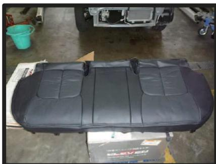
③シートを車外へと運び出します。車体本体に傷などを付けない様に慎重に行ってください。シートのラインに合わせて、カバーをシート全体にかぶせます。
