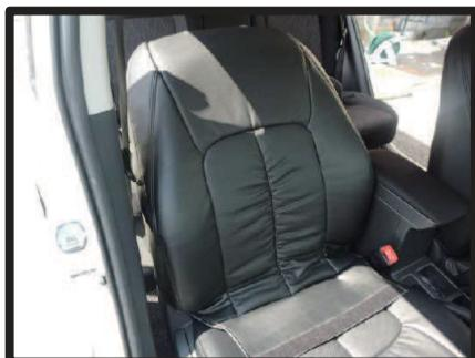
③カバーをシートのラインからずれないように左右均等に引き下ろし、シート全体にかぶせます。
