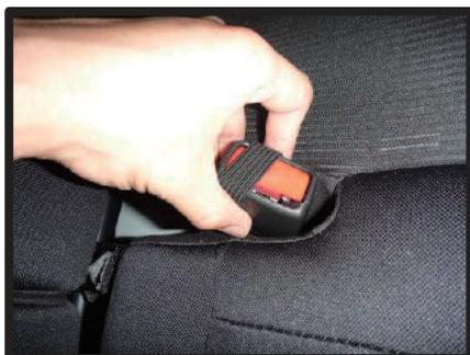
②助手席側のシートベルトバックルがゴムで固定されていますので外します。
