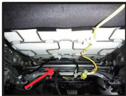
⑨カバー前方に付いているベルトをシート裏を通しシート背面から引き出します。この際ベルトは、スライドレバー、矢印の金属部分の上を通して下さい。(シート背面からの図)
