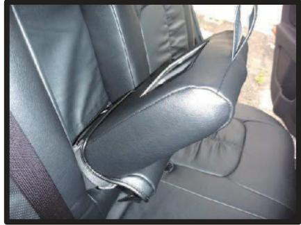
①アームレストのラインに合わせて、カバーを半分ほど裏返してかぶせます。アームレストの先端までしっかりとかぶせて下さい。
