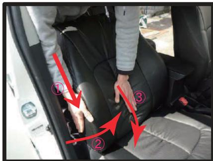
⑧①～③の手順で側面のシワをシート中央に寄せて、そのまま下になぞるようにカバーをシートに馴染ませていきます。シート側面のシワが無くなるまで続けて下さい。
