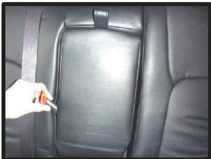
⑭アームレスト収納部のシワを無くしシートに早く馴染ませるためには、カバー取り付け後アームレストをしっかりシートに収納させヘラ等で内部の生地を整えて一週間ほどそのままの状態を保っていただくと生地に型が付き、シワが解消されます。
