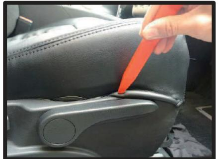
⑥シート側面の生地をプラスチック部の隙間に入れ込みます。ヘラ等を使用すると作業が行いやすくなります。
