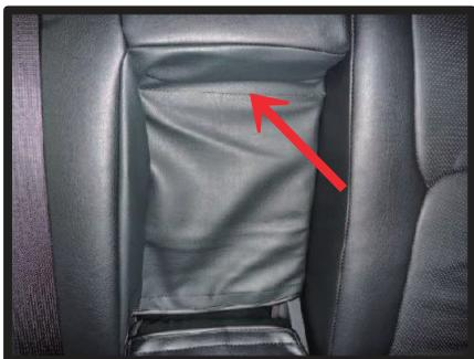
⑬アームレスト収納部の図です。カバー取り付け後すぐは生地が馴染まないためシワがよります。矢印部分の生地裏に収納部の形が形成されやすいようにプラスチックの板が付いています。
