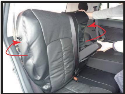
①カバー背面のファスナーを開けて、シートに矢印方向へ巻き付けるようにかぶせます。この際、アームレストはカバーの加工穴から取り出します。
