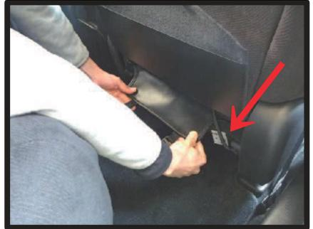
⑤入れ込んだ生地をシート背面から引き出します。矢印部分にサイドエアバッグの配線が出てますので、配線をかかわして生地を引き出して下さい。
