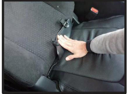
④背もたれと座面の隙間に生地を入れ込みます。背もたれの角度を調整して入れ込みやすい位置で行ってください。
