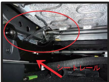
⑧ゴムは座面裏の金属部分に引っ掛け固定します。この際、シート側面の生地をめくり、図の隙間からゴムを取り出すようにして下さい。ゴム固定後はシートをゆっくりスライドさせて、ゴムが干渉していないか確認して下さい。
