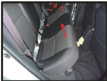
①2列目座面カバーはシートを車体から外して取り付けを行います。シートは矢印位置の裏2カ所でフックで固定されていますので、矢印方向に持ち上げることで外れます。
