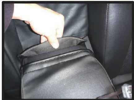
③アームレストを倒して入れ込んだ生地を引き出します。引き出した生地をマジックテープで固定します。
