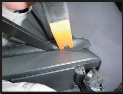
④アームレスト側面にも生地を入れ込みます。側面は隙間が大変狭いため図のようにヘラを2本使い片方のヘラで隙間を広げ、もう片方のヘラで生地を入れ込むと作業が行いやすくなります。
