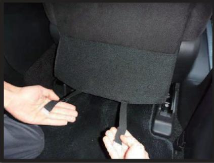
①始めにシート背面からシート裏にかぶっているカバーを外します。カバーはフック2ヵ所でシート裏の金属部分に引っ掛け固定されています。
