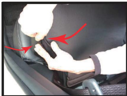
⑯助手席側は一部形状が異なります。シート側面のファスナーは生地を内へ寄せながら慎重に閉じます。固定はシート背面で運転席側同様に、マジックテープで固定します。
