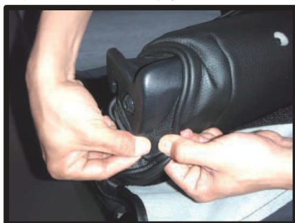
③後ろ側から徐々にロックを穴から取り出していきます。生地の伸びを利用し十分に取り出せませんが、作業は慎重に行なって下さい。
