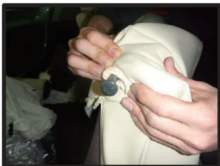
②カバー背面のファスナーを開きシートにかぶせます。始めにカバーの加工穴からシート固定金具を取り出します。
