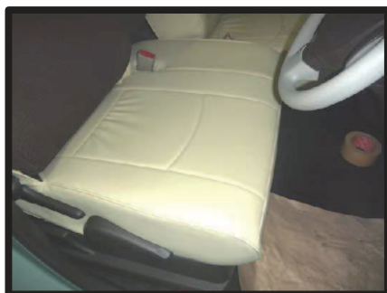
㉔カバーのラインを整えて、1列目運転席側座面の完成です。助手席側は5ページ6ページのセパレートシートの取り付けを参考にして下さい。
