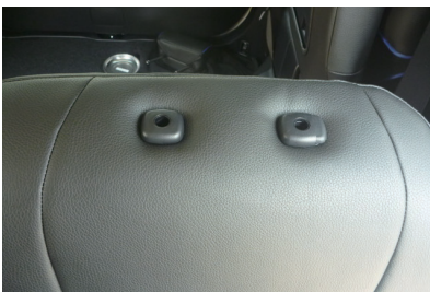
33 ヘッドレストの台座を取り出します。
