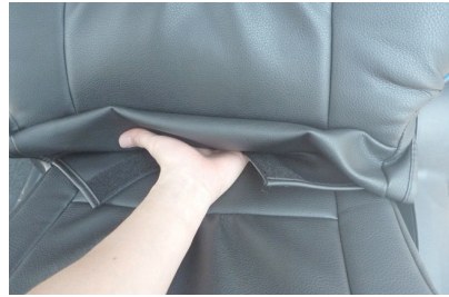
34 背もたれと座面の隙間に生地を入れ込みます。
