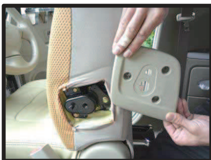
⑥背もたれのプラスチック部品を外します。
