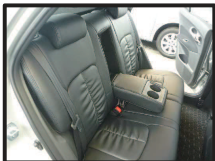
⑰カバーのラインを整えて、2列目背もたれの完成です。 助手席側も一部形状は異なりますが同様に取り付けます。
