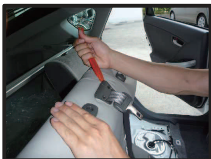
⑮マイナーチェンジ後の車は、中央のシートベルトが出ているフチに生地を入れ込みます。
