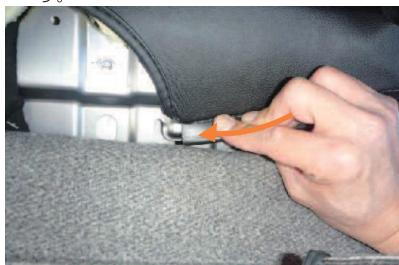
21 シート表皮を固定していた部分にカバーに付いているフックを固定します。カバーのフックは隙間が狭いためシート表皮のフックのようには引っかかりません。フックを固定部の横から滑り込ませるようにして、引っかけます。固定部には1箇所ずつ引っかけていきます。始めに滑り込ませる固定部に、少し余分に入れ込みます。
