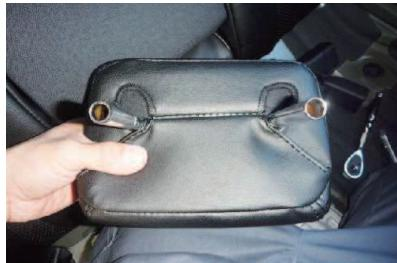
10 こちらは2列目中央ヘッドラストの裏の図です。2列目ヘッドラストはカバーを少しでもかぶせやすくするために、軸周りの穴を大きめに開けています。
