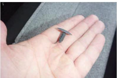
2 シート背面の生地の固定を外します。背面の生地は図の、先がギザギザしているピンで固定されています。
