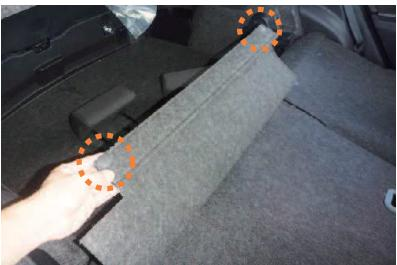
3 始めにラゲージ部分につながっている図の生地を外します。生地は丸印の位置2箇所にピンで固定されています。ピンはピン周りの生地を掴み、垂直に持ち上げると外れます。
