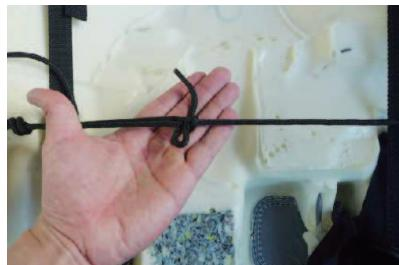
10 通したヒモを引くことでシートの下周り部分のカバーが絞り込まれます。ヒモはシートの下回りを絞り込み結び留めます。
