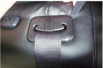
26 中央のシートベルトが出ているプラスチック部のフチに生地を入れ込みます。
