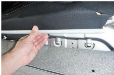
20 シート背面からシート表皮の固定を外します。シート表皮は図の白いフックで固定されています。白いフックの引っかかりを外して固定を外します。外した生地部分は折りたたみカバーの生地で隠れるようにします。
