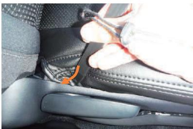
8 シートの付け根部分は隙間が大変狭くなっています。付け根部分は生地を真っ直ぐに入れ込みず、プラスチック部内側のフチに生地を沿わすように入れ込みます。
