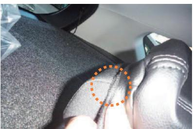
8 2列目ヘッドラスト後ろ側にカバーをかぶせていく際は、図の丸印部分に負荷がかかりやすいので、しっかり生地を馴染ませながら慎重にかぶせて下さい。
