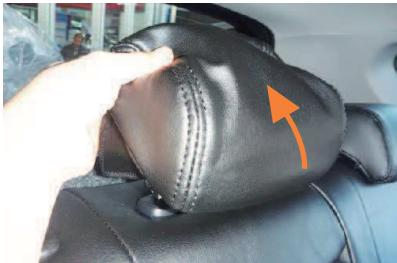
7 2列目ヘッドラストです。2列目ヘッドラストは図の矢印方向に、ヘッドラストのラインに合わせて下から上へかぶせます。カバーは平らなプラスチックが付いている方が前になります。
