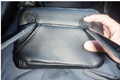
9 ヘッドラスト裏で1列目同様にプラフックを固定します。
