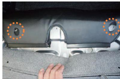
23 フックの端と端に固定部が来るよう引っかけると図のように固定できます。カバーの加工穴から、12ページ4番で外したビンの穴が見える状態にして下さい。
