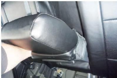
1 カバーを半分程裏返して、アームレストのラインに合わせてかぶせます。この際アームレストの先端までしっかりととかぶせて下さい。
