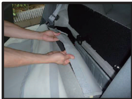
⑭背もたれを前に倒し、カバー前面の生地を引き出します
