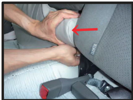
⑧背もたれの付け根にあたるアームレスト下の側面部分に生地を入れ込みます。
