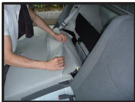
⑱⑭で引き出した生地を背もたれ背面とマジックテープで固定します。
