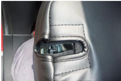
14 背もたれを車体に固定する金具が収まる位置には、カバーにマジックテープが付いていますのでシートの形状に合わせて直接固定します。
