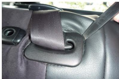
6 シートベルト部の隙間にも生地を入れ込みます。
