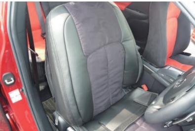
1 カバー側面に付いているファスナーを開いた状態で、シートのラインに合わせカバーをかぶせます。
