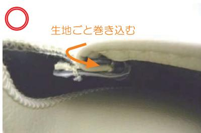
2 プラフックの固定方法は、カギ状のプラフックに板状のプラフックを、生地ごと巻き込むようにめ込み固定します。
