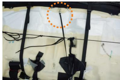
11 カバーに付いているゴムに付属の金属フックを取り付け、図の丸位置に引っ掛け固定します。
