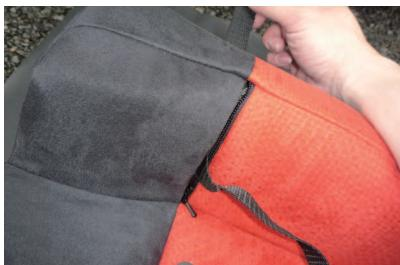
8 開いたファスナーの隙間に、カバーに付いているベルトを通します。
