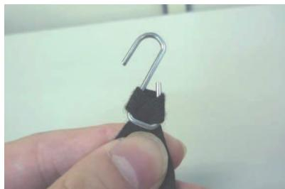
3 かぶせたゴムを引き絞る事で、図のように金属フックがゴムに固定され、外れにくくなります。
