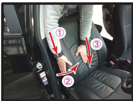
⑥図の①～③の順番に生地をなで下ろして、背もたれ中央下に寄った生地を、シート背面から⑤の生地を引き直して伸ばします。この作業を繰り返して、シートに密着させるようにカバーのシワを無くしていきます。
